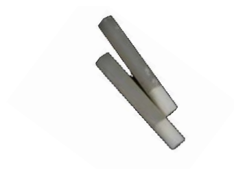
Figura 3 – Ilustração das amostras em forma de palitos, com 1 mm 2 de área de secção transversal.
