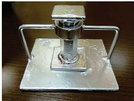
Figura 24 – Equipamento confeccionado pela oficina da Faculdade de Odontologia UPF para realizar pressão de assentamento
