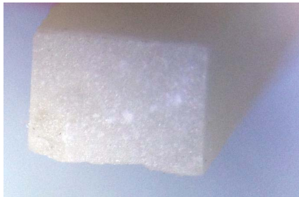
Figura 5 – Resina – falha adesiva
