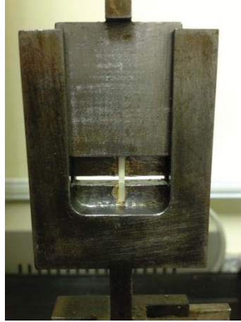
Figura 27 – Ilustração do dispositivo metálico em forma de guilhotina, desenvolvido pelo Departamento de Engenharia Mecânica da Universidade de Passo Fundo
