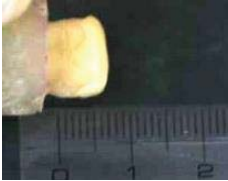
Figura 19 – Ilustração da confecção das restaurações em forma de platô com altura de 6mm
