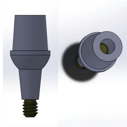
Figura 8 - Modelo do munhão com parafuso passante simplificado
