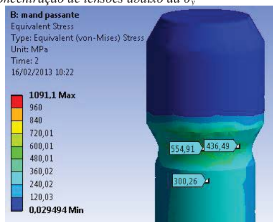
Figura 43 - Secção superior do parafuso retentor (M 2), maiores valores de tensão entre 300 e 555 MPa
