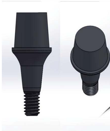
Figura 7 - Modelo do munhão sólido simplificado
