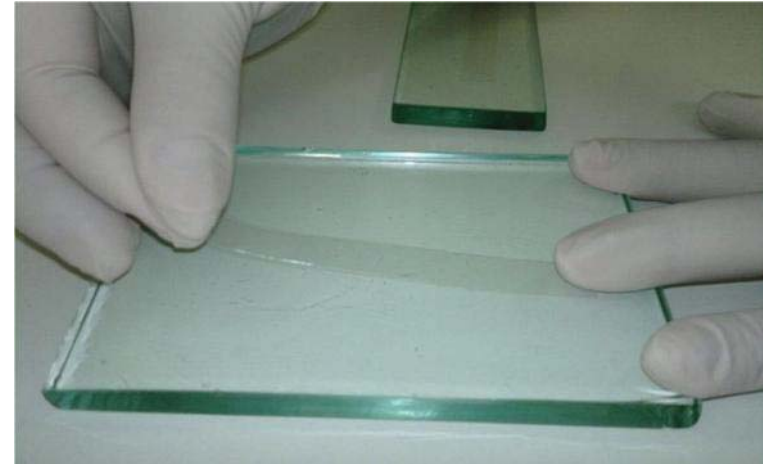
Figura 12 – Fabricação dos CPs de resina: tira de matriz de poliéster sobre placa de vidro.
