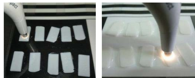
Figura 36 – Medição das coordenadas Lab sobre fundos branco e preto com o Easyshade. Os CPs estão colocadas em substância acoplante (glicerina) em fundo padrão preto ou branco.
