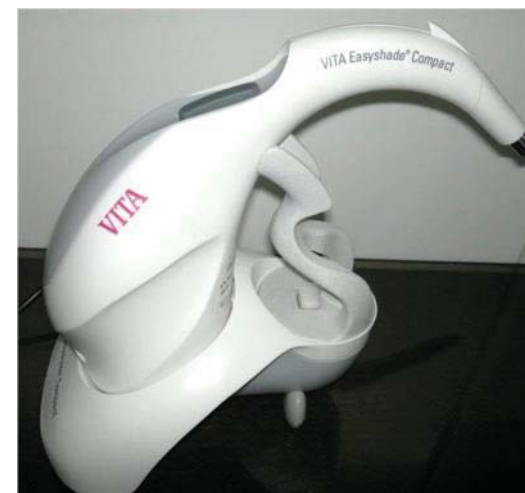
Figura 35 – Espectrofotômetro VITA Easyshade Compact.
