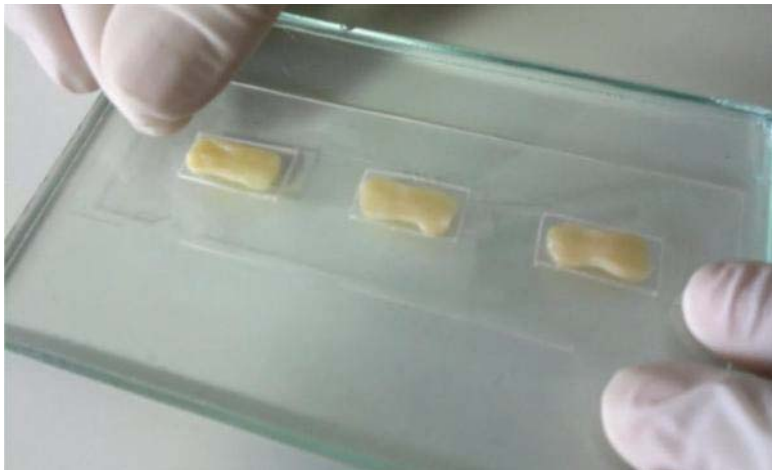
Figura 15 – Fabricação dos CPs de resina: colocação da segunda tira de poliéster sobre a resina composta.
