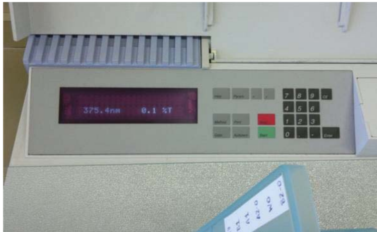
Figura 33 – Mensuração da T% em progresso no espectrofotômetro Lambda20. Painel mostra comprimento de onda e respectivo percentual de transmitância direta no CP.
