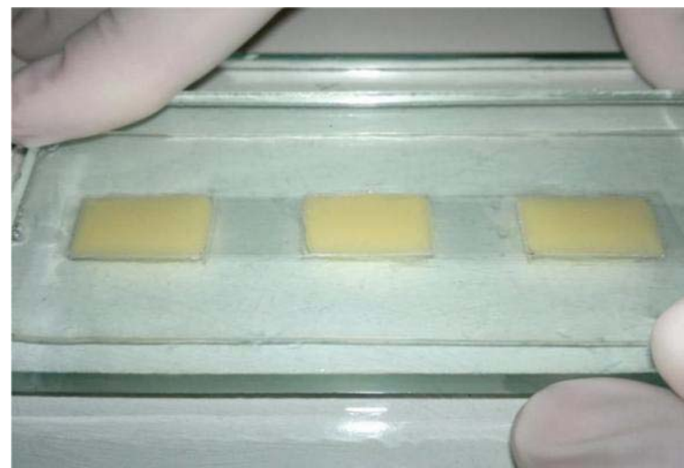
Figura 17 - Fabricação dos CPs de resina: prensagem com segunda placa de vidro.
