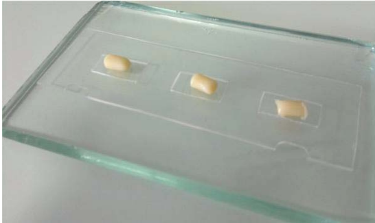
Figura 14 – Fabricação dos CPs de resinas: disposição da resina composta nos moldes.
