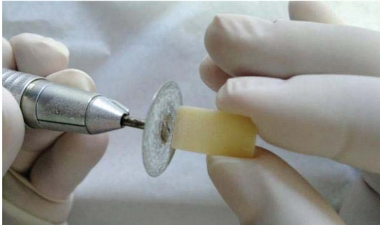
Figura 22 - Fabricação dos CPs de resina: acabamento das bordas laterais dos CPs com disco diamantado em baixa rotação.
