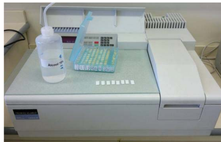
Figura 32 – Espectrofotômetro Lambda 20 em uso. CPs limpos aguardando varredura.
