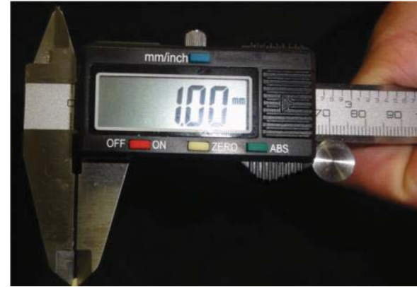
Figura 24 – Paquímetro digital medindo espessura dos CPs.
