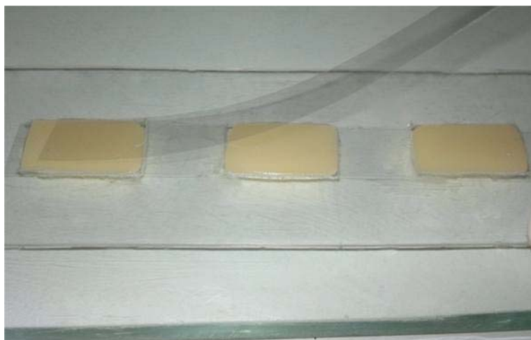
Figura 19 – Fabricação dos CPs de resina: remoção da tira de poliéster após polimerização.
