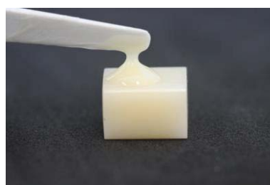
Figura 11 – Aplicação do cimento no bloco cerâmico.
