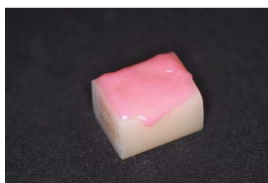
Figura 4 – ác. hidrofluorídrico aplicado na cerâmica feldspática.
