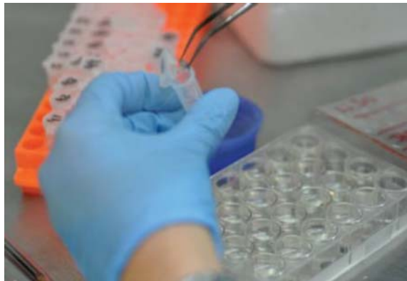
Figura 7 – Foto ilustrativa mostrando a remoção dos discos de Ti cp das placas de micropoços para os tubos contendo 1 ml RTF, para posterior sonicação.
