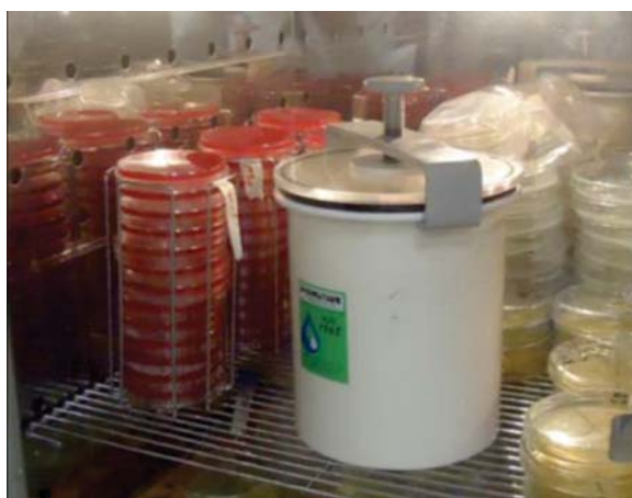
Figura 8 – Foto ilustrando as placas de Ágar sangue sendo incubadas em estufa bacteriológica e jarras de anaerobiose para posterior contagem de microrganismos totais (UFC/mg).
