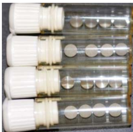
Figura 4 – Remoção da cápsula contendo os discos de Ti cp para a verificação da R_a – continuação.
