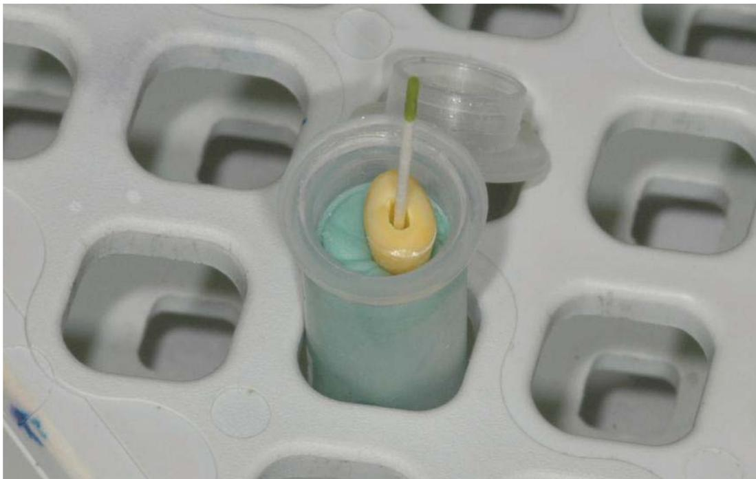
*Figura II.9 - Cone de papel inserido na amostra preenchida com solução de Ringer.*
