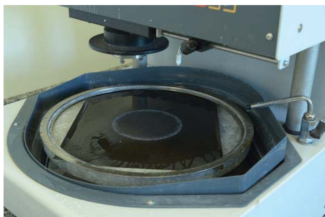
Figura 2. Máquina Politriz utilizada para polimento das barras.
