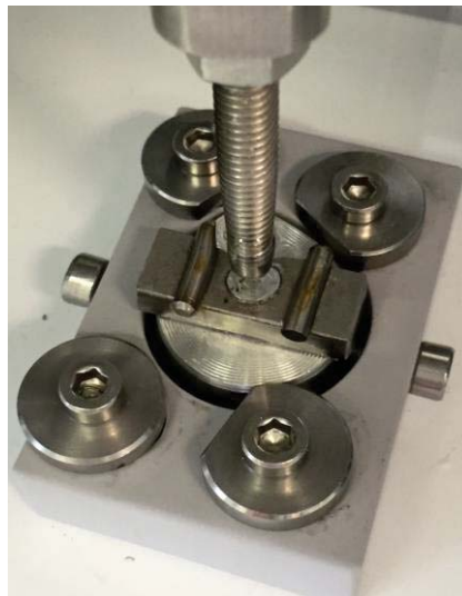
Figura 8. Dispositivo de ensaio posicionado e fixado na máquina de ciclagem.
