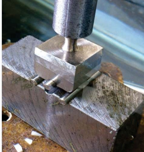
Figura 5. Dispositivo para o teste de flexão em três pontos.
