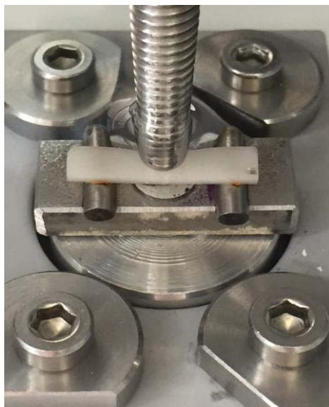
Figura 10. Barra do grupo VL sendo submetida a ciclagem mecânica, completando 100 mil ciclos.
