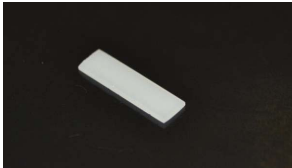
Figura 4. Barra do grupo VD após sinterização
