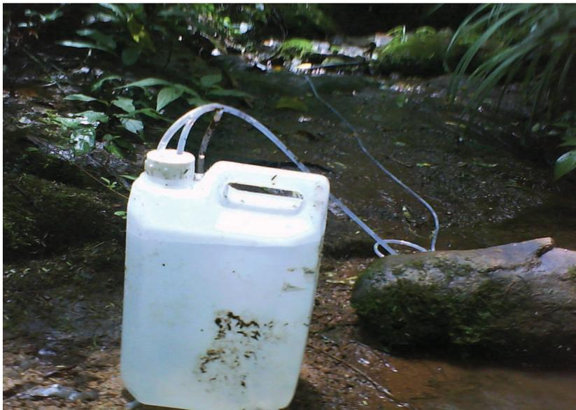
Figura 4 - Amostrador de água e sedimentos utilizado na amostragem na BH, linha 16, Vila Maria – RS. FAMV, Passo Fundo, RS
