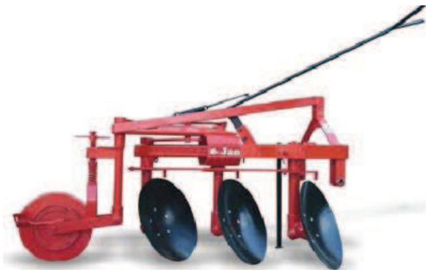
Figura 2: Arado com discos de 28 polegadas de diâmetro.
