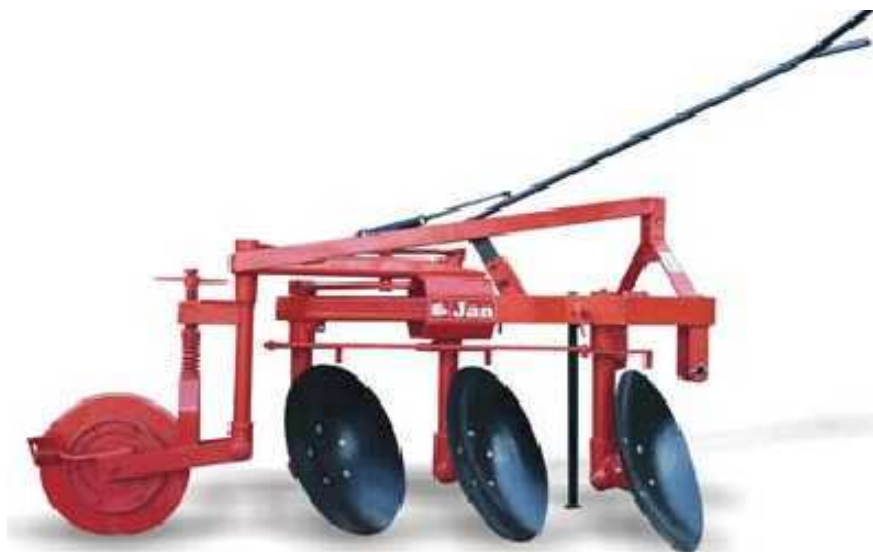
Figura 2: Arado com discos de 28 polegadas de diâmetro (Catálogo Jan).
