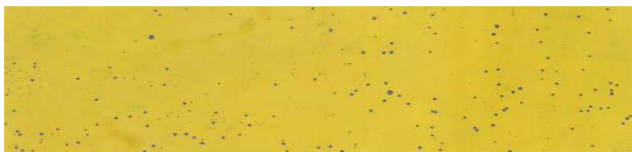
Figura 4 – Imagem digitalizada de cartão sensível com marcas dos impactos de gotas da pulverização obtido no terço inferior das plantas com espaçamento de 0,40 m entre linhas e volume de 50 L.ha -1 . A análise do cartão revelou densidade média de 16,2 impactos de gotas.cm -2 , DMV de 191 µm e volume de calda depositado de 5,6 L/ha.
