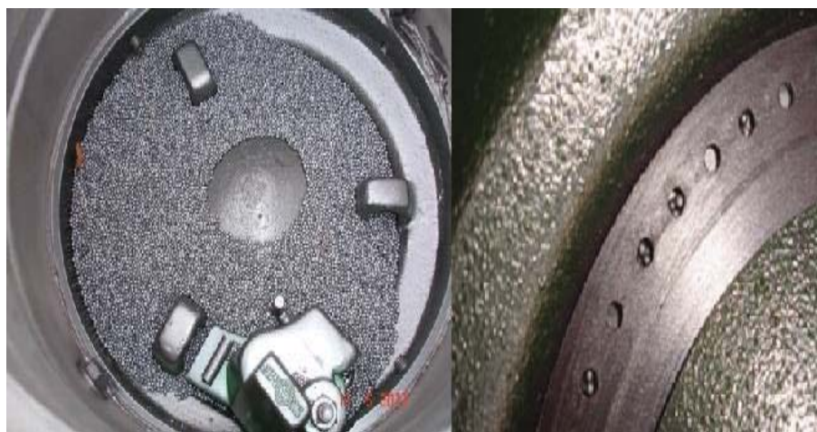
Figura 8. Padrão de plantabilidade de sementes de canola incrustadas do híbrido Hyola 61 em disco alveolado. Local: Passo Fundo, RS, 2012. Foto: Boller, W.
