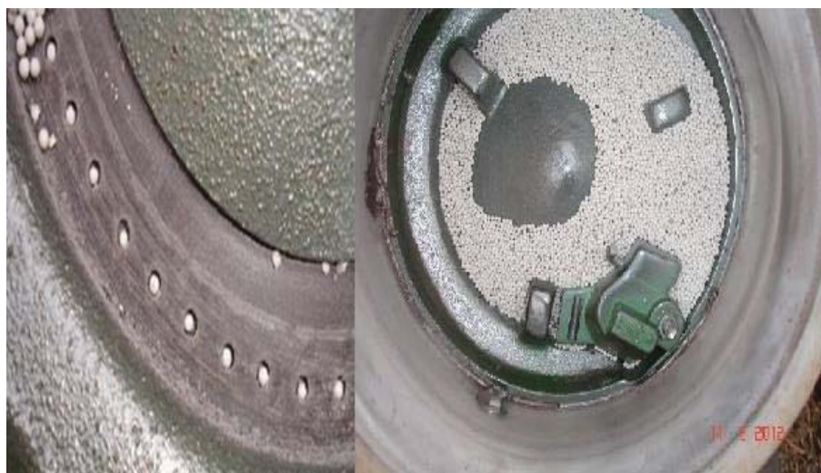
Figura 4. Padrão de plantabilidade de sementes de canola incrustadas do híbrido Hyola 61 em disco alveolado. Local: Passo Fundo, RS, 2012. Foto: Boller, W.
