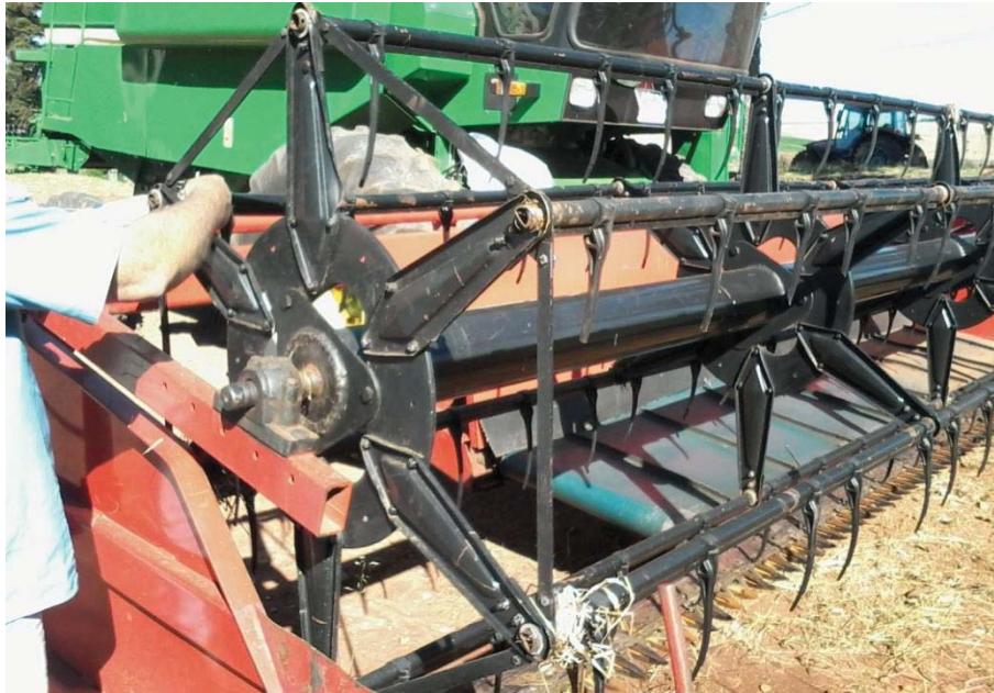
Figura 5. Plataforma de corte-enleiramento utilizada para confecção das leiras de canola. Local: Passo Fundo, RS, 2014. Foto: Pizolotto, C. A.
