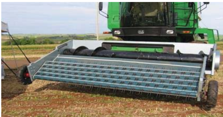
Figura 3. Plataforma desenvolvida para o recolhimento de leiras de canola corte-enleiradas. Passo Fundo, RS, 2011. Foto: Boller, W.
