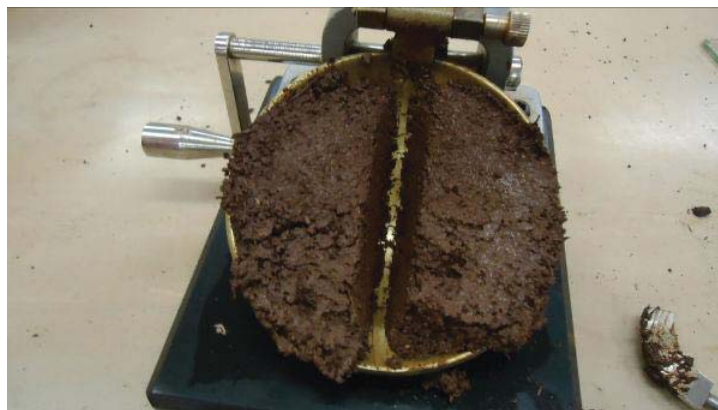
Figura 9 - Aparelho de Casagrande, utilizado para determinar o limite de líquido. FAMV/UPF, Passo Fundo, RS, 2012
