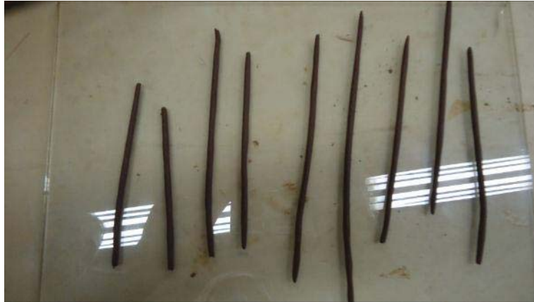
Figura 8 - Cilindros moldados manualmente para determinar o limite plástico. FAMV/UPF, Passo Fundo, RS, 2012
