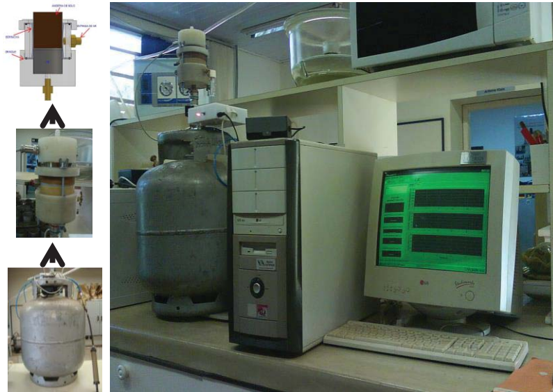
Figura 6 - Dispositivo utilizado na determinação da permeabilidade a ar. FAMV/UPF, Passo Fundo, RS, 2012
