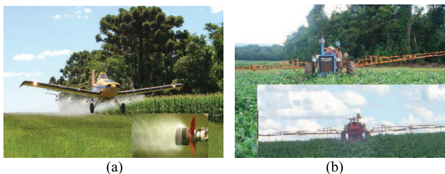
Figura 1. Equipamentos de pulverização utilizados nos experimentos: (a) aeronave Ipanema modelo EMB-201-A com destaque para o atomizador rotativo de tela; (b) trator equipado com pulverizador marca Jacto ® modelo Condor.
