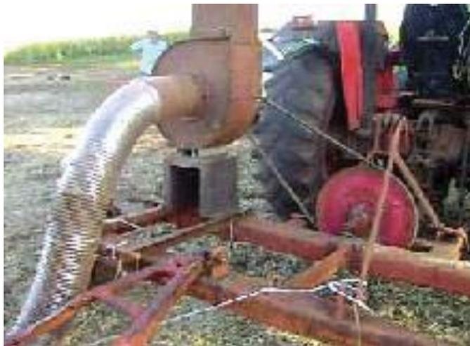
Figura 24 - Turbina fixa sobre o chassi e acoplado ao trator Massey Ferguson, modelo 275, ano 2005. Passo Fundo - RS. Acervo do autor
