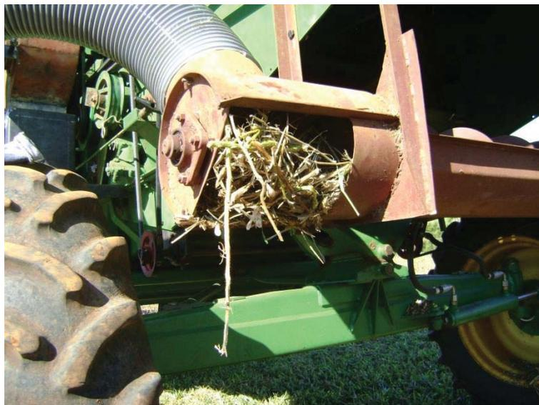
Figura 17 - Vista da abertura inferior do tubo da rosca sem fim, com acúmulo de material. Passo Fundo - RS. Acervo do autor
