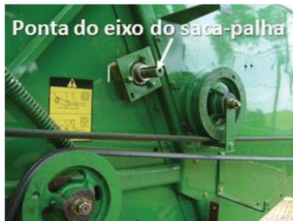
Figura 20 - Ponta do eixo do saca-palha utilizado para acionar a rosca sem fim. Passo Fundo - RS. Acervo do autor
