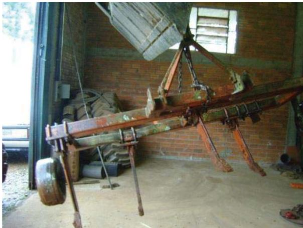
Figura 26 - Chassi usado para acoplamento da turbina no trator. Passo Fundo - RS. Acervo do autor
