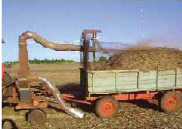
Figura 25 - Turbina aspirando o palhiço do solo e depositando em carreta agrícola. Passo Fundo - RS. Acervo do autor
