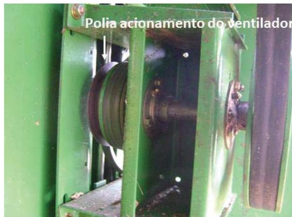
Figura 19 - Eixo de acoplamento da polia de acionamento do ventilador. Passo Fundo - RS. Acervo do autor
