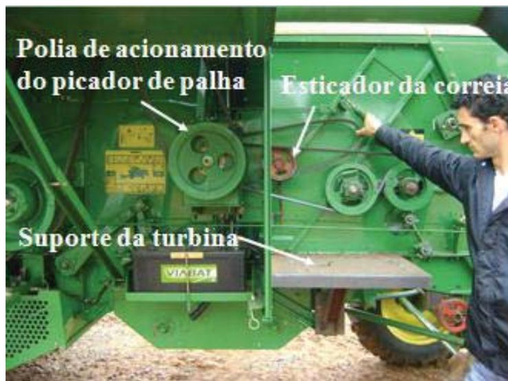
Figura 18 - Localização da polia de acionamento do picador de palha, esticador da correia e o suporte de fixação da turbina. Passo Fundo - RS. Acervo do autor
