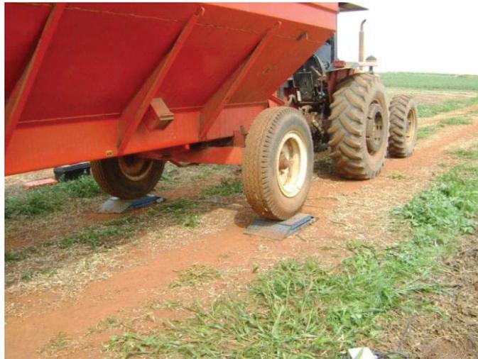
Figura 5 – Pesagem, com auxílio de uma célula de carga, dos grãos e palhiço coletados na safra 2011/2012. Passo Fundo - RS. Acervo do autor
