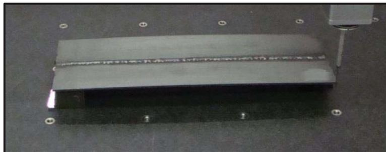
Figura 29: Conjunto de prova soldado ARBL S 700 MC.
