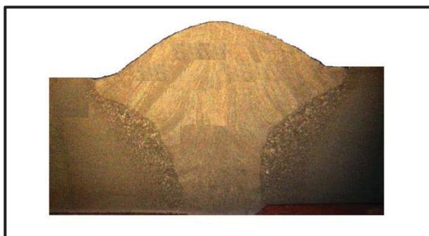
Figura 68: Macrografia do novo perfil da junta soldada pelo processo GMAW.
