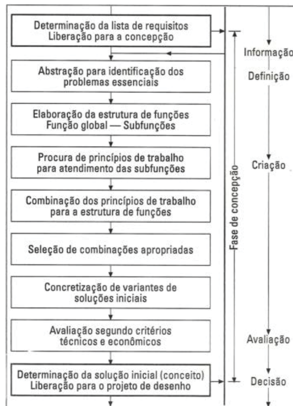
Figura 6 - Etapas de trabalho para a fase de concepção Fonte: Phal et al., 2005, p.112
