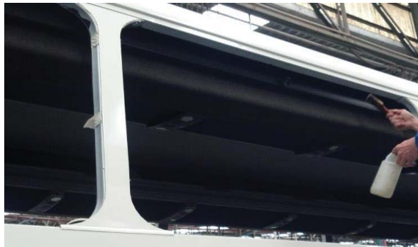
Figura 39 - Aplicação de lubrificante Fonte: Comil ônibus S.A, 2013
