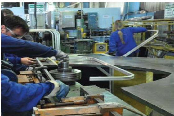
Figura 29 - Dobra do perfil de alumínio Fonte: Comil ônibus S.A, 2013.
