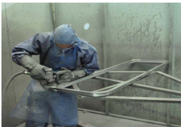
Figura 32 - Acabamento do perfil da janela Fonte: Comil ônibus S.A, 2013.
