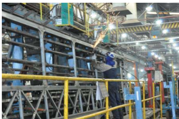
Figura 37 - Preparação das laterais Fonte: Comil ônibus S.A, 2013.
