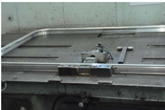
Figura 30 - Soldagem do perfil de alumínio Fonte: Comil ônibus S.A, 2013.
