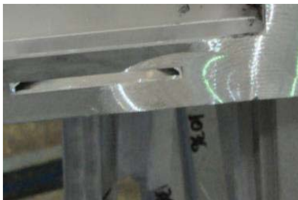
Figura 31 - Entalhe no perfil da janela Fonte: Comil ônibus S.A, 2013.
