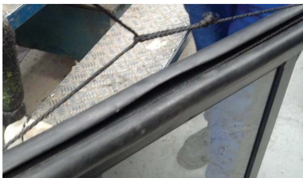
Figura 38 - Envolvimento do cordão no perfil de borracha Fonte: Comil ônibus S.A, 2013.
