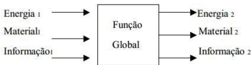
Figura 7 - Representação da função global do sistema Fonte: Pahl et al., 2005, p.120
