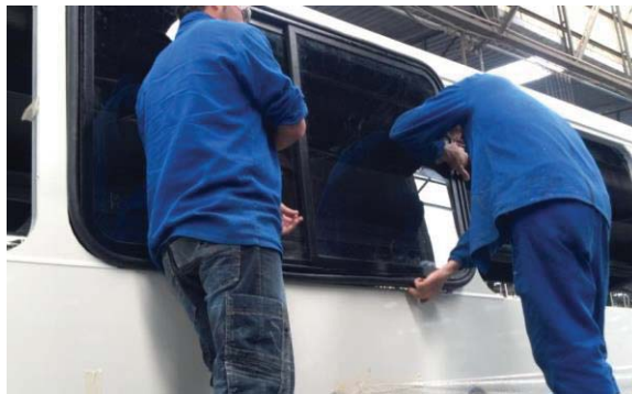
Figura 40 - Janela sendo posicionada para montagem Fonte: Comil ônibus S.A, 2013.
