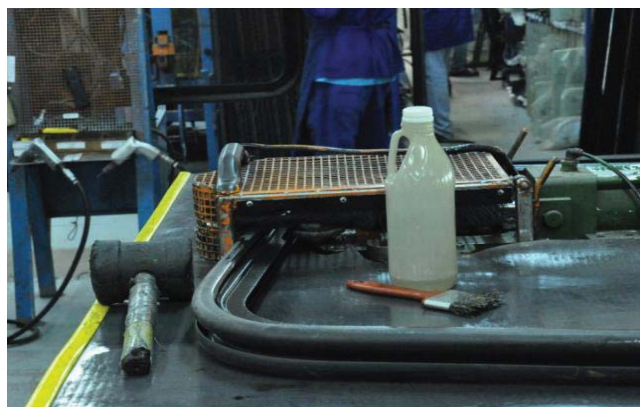
Figura 34 - Montagem do perfil de borracha Fonte: Comil ônibus S.A, 2013.
