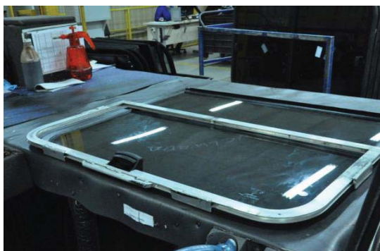
Figura 35 - Ajuste das janelas de correr Fonte: Comil ônibus S.A, 2013
