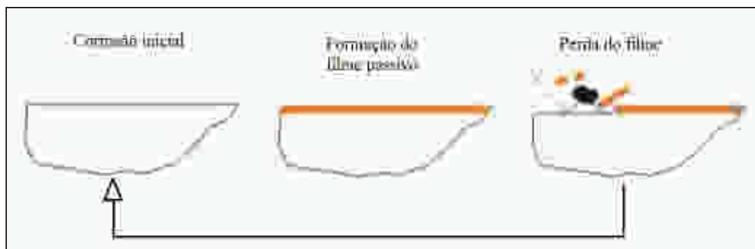
Figura 16 - Mecanismo de remoção de camadas passivas.
