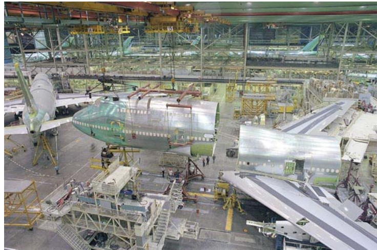
Figura 2.11 - Processo de montagem da fuselagem do Boeing 747 (Fonte: www.boeing.com )
