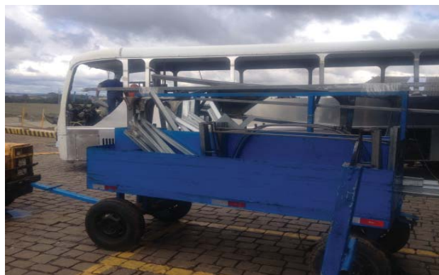
Figura 4.4 - Carrinho de peças da lateral (Fonte: Imagens repassadas pela empresa)
