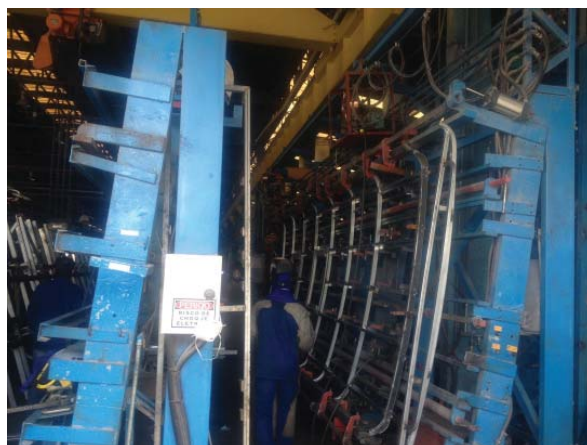
Figura 4.7 - Gabarito do teto (Fonte: Imagens repassadas pela empresa)
