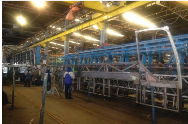
Figura 4.8 - Gabarito da lateral (Fonte: Imagens repassadas pela empresa)
