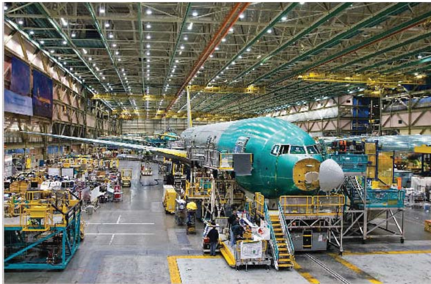
Figura 2.10 - Linha móvel de montagem do Boeing 747 (Fonte: revista Assembly dez/2006 )
