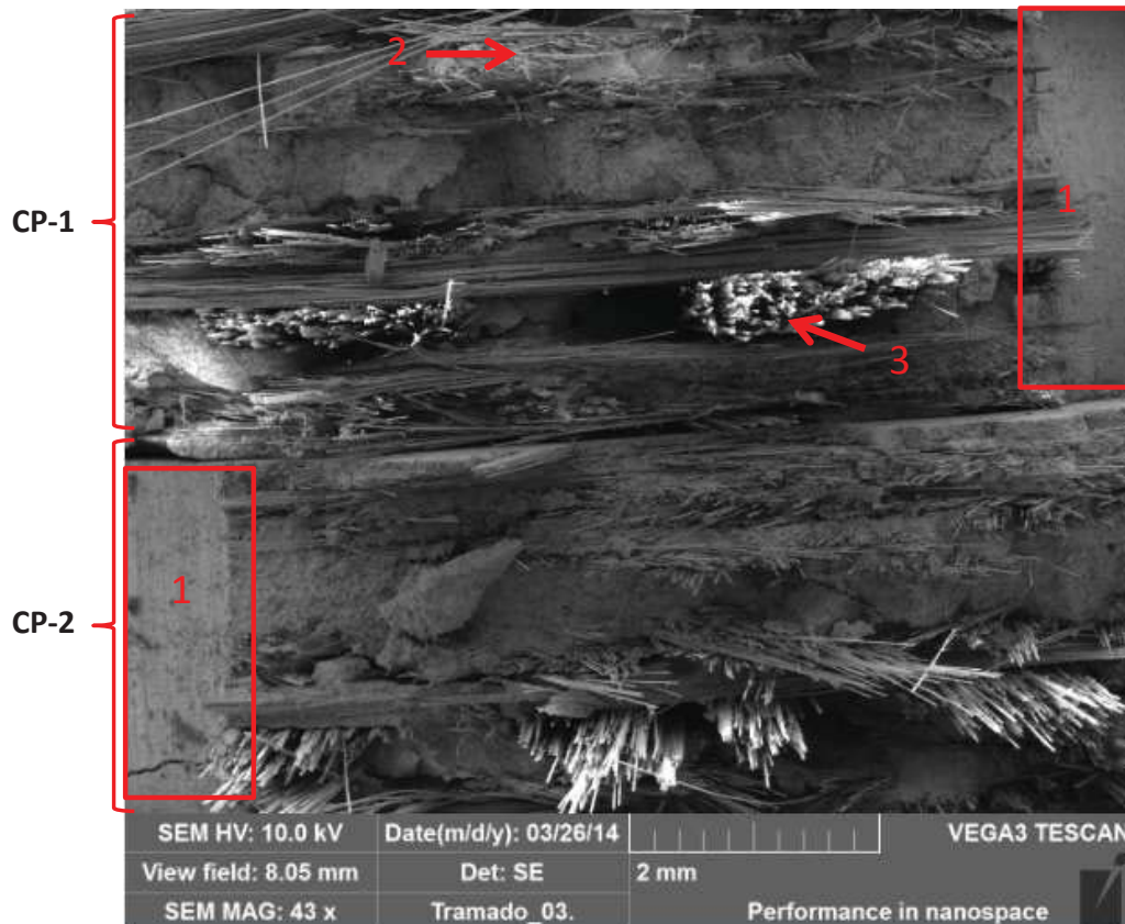
Figura 32 - Visão geral do material PRFV pultrudado após ensaio de impacto.
