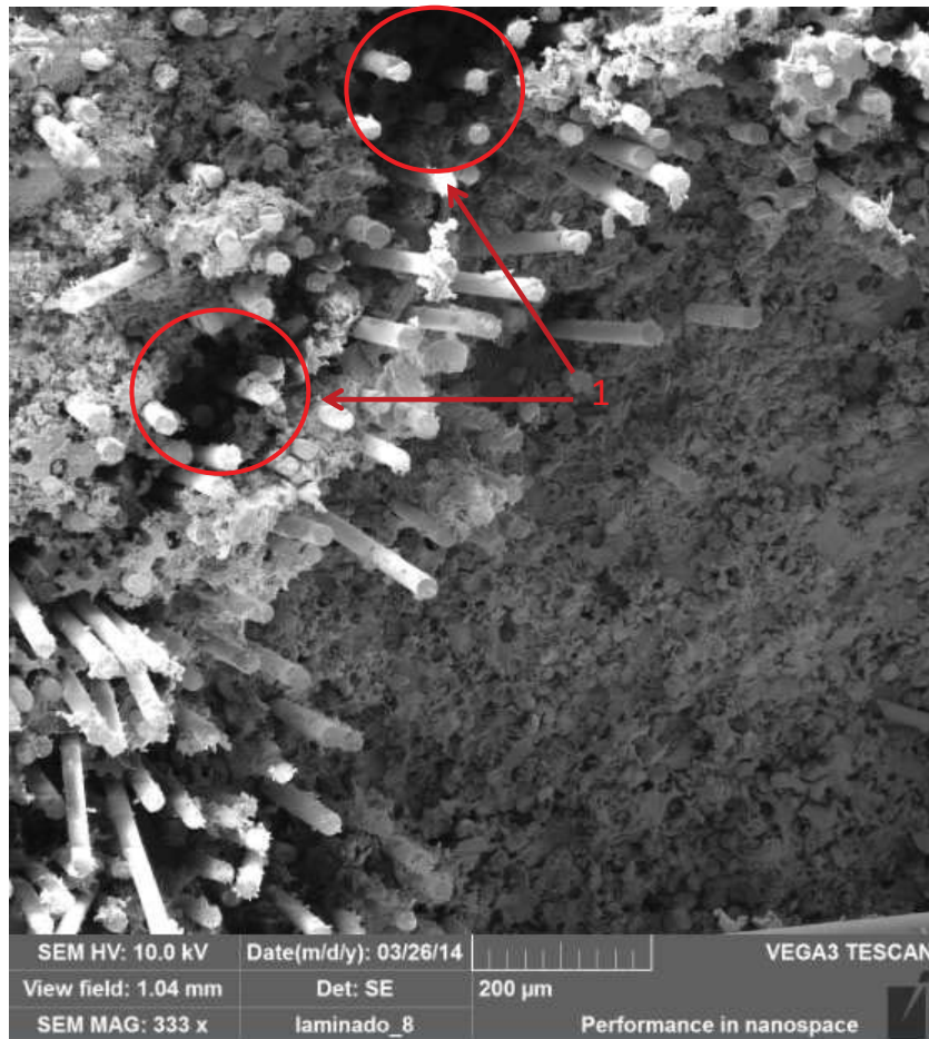
1- Detalhes de fratura coesiva da matriz. Ampliação 333 vezes. Fonte: Autor.
