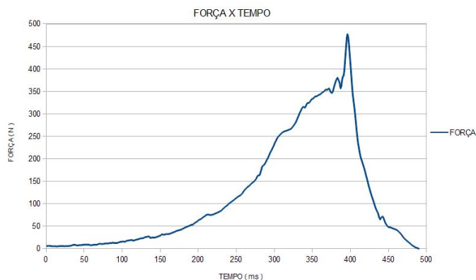
Figura 24 – Força solicitada no fechamento (Laboratório de Ensaios Mecânicos UPF)
