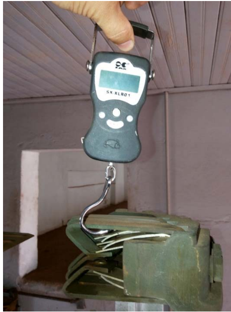
Figura 26 – Dinamômetro medido força da mola
