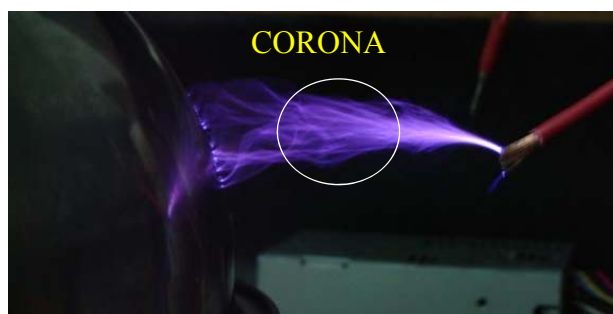
Figura 10 – Efeito corona diferença de potencial elevado
