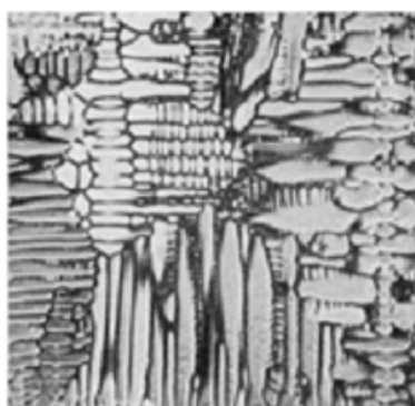
Figura 7- Amostra da estrutura dendrítica do cobre (METALS HANDBOOK, 1992)
