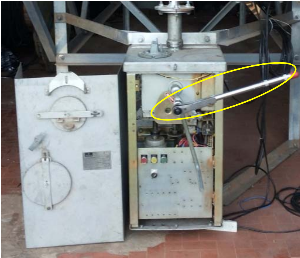
Figura 27 – Torquímetro acoplado a caixa de redução acionamento manual
