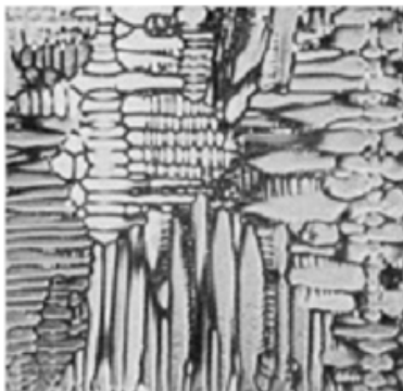
Figura 29 Amostra da estrutura dendrítica do cobre eletrolítico (METALS HANDBOOK, 1992)
