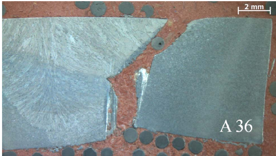
Figura 4.16 – Macrografia da região de fratura das juntas soldadas (6,5X – Nital 5%)
