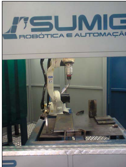
Figura 3.3 - Célula robotizada SUMIG Anglecell (Laboratório de soldagem da UPF)
