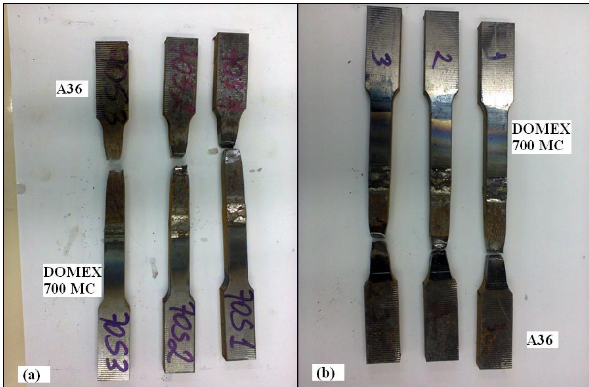
Figura 4.13 – (a) Corpos de prova de tração da JS1; (b) Corpos de prova de tração da JS2
