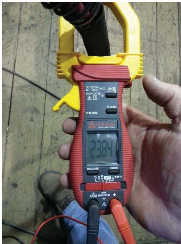
Figura 86: Conferência dos parâmetros de soldagem registrados pelo aparelho de solda
