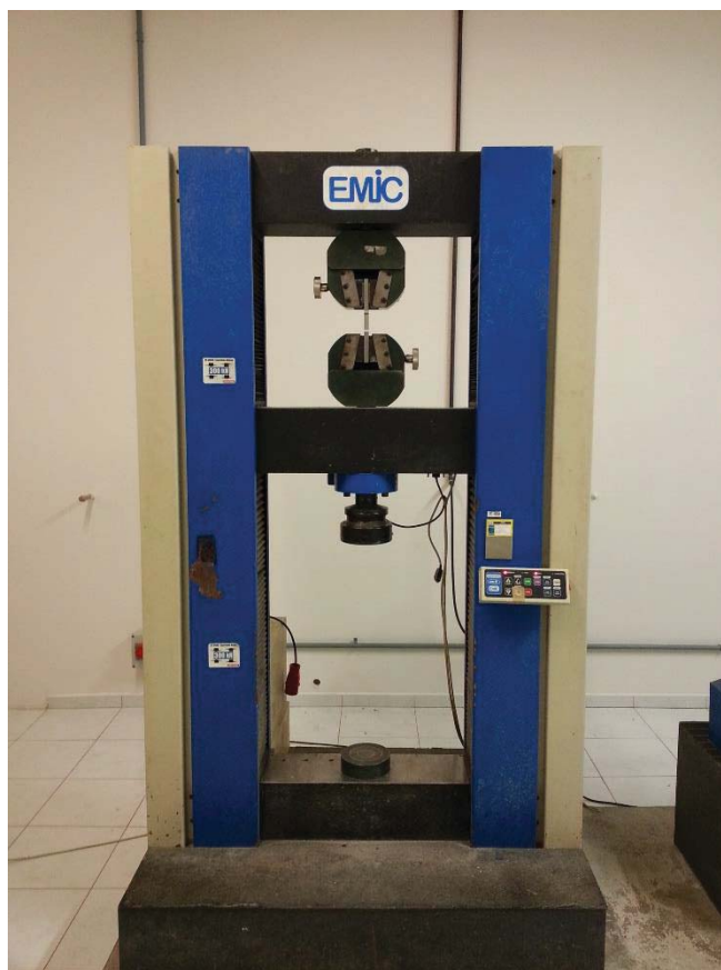
Figura 89: Máquina universal de ensaios da UNOESC Joaçaba/SC, utilizada para os ensaios de tração
