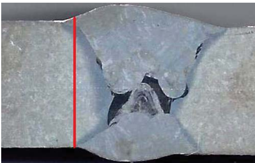
Figura 81: Região do entalhe para o ensaio de impacto Charpy na ZTA
