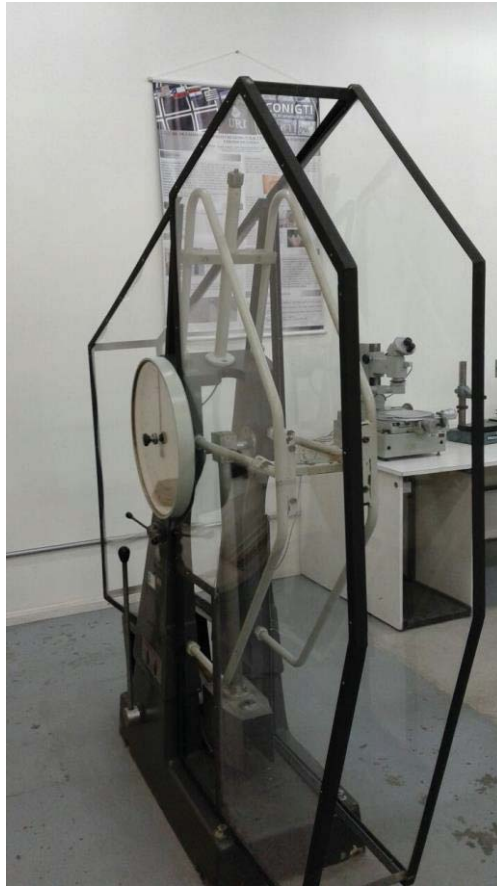
Figura 93: Máquina de ensaio de tenacidade ao impacto da UPF/Passo Fundo
