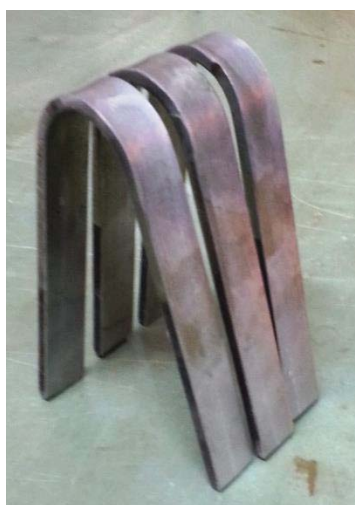
Figura 67: Corpos de prova após ensaio de dobramento lateral à solda
