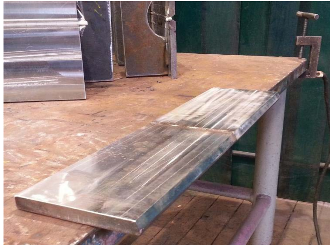
Figura 34: Chapas posicionadas para amateigamento do chanfro
