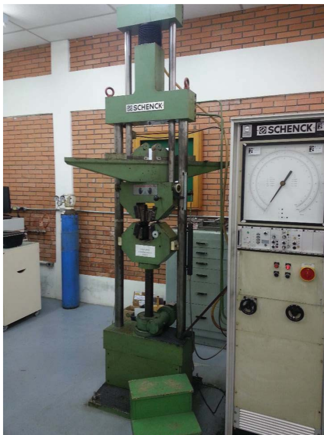
Figura 91: Máquina de ensaios universal da UPF/Passo Fundo utilizada para os ensaios de dobramento lateral à solda
