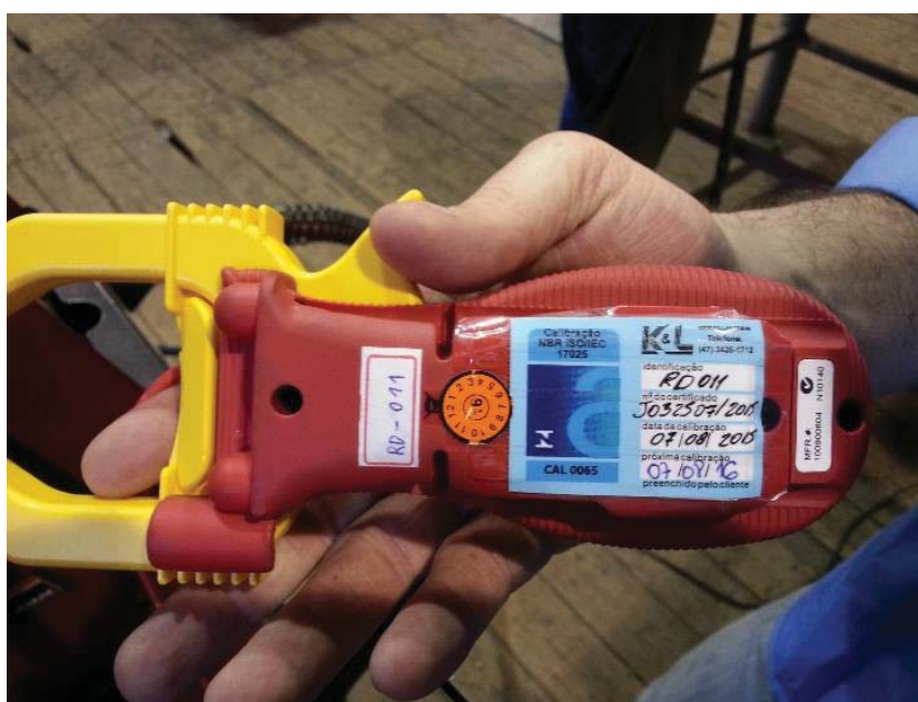
Figura 87: Certificado de calibração do medidor de corrente e tensão
