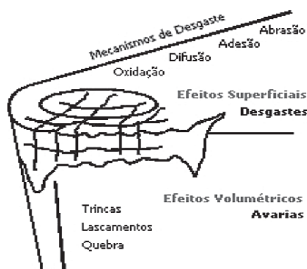
Figura 11 - Tipos de falhas nas ferramentas de corte no torneamento.
