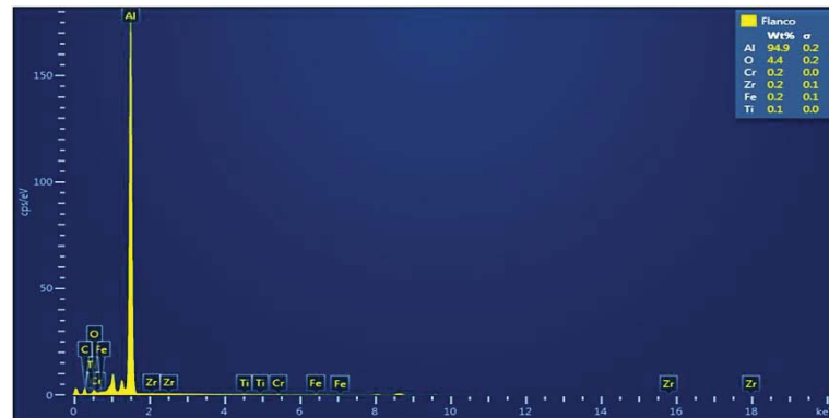
Figura 63 - Composição química do flanco da área demarcada na região “C” da Figura 60 (b).
