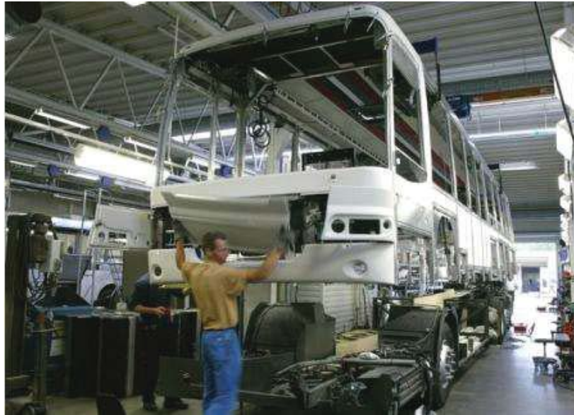
Figura 3 – Montagem carroceria de ônibus.
