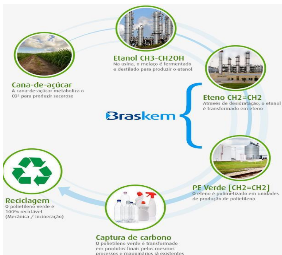
Figura 14 – Reação química de transformação do etanol em plástico verde
