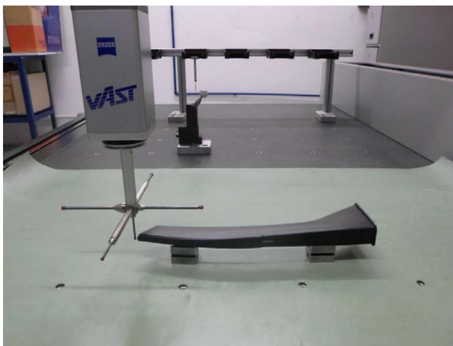
Figura 300 – Análise dimensional em equipamento de medição tridimensional Zeiss Prismo
