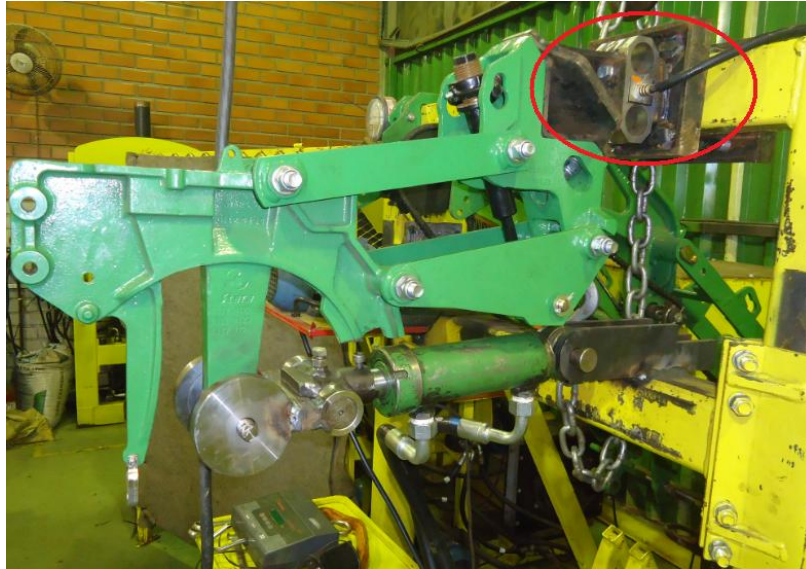
Figura 12 – Calibração da célula de carga.
