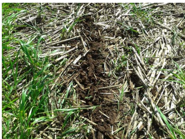
Figura 20 - Suporte de 38° na velocidade de 12 km/h, 50 mm profundidade.
