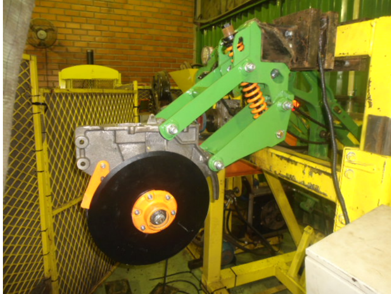
Figura 21 - Montagem do suporte e discos.
