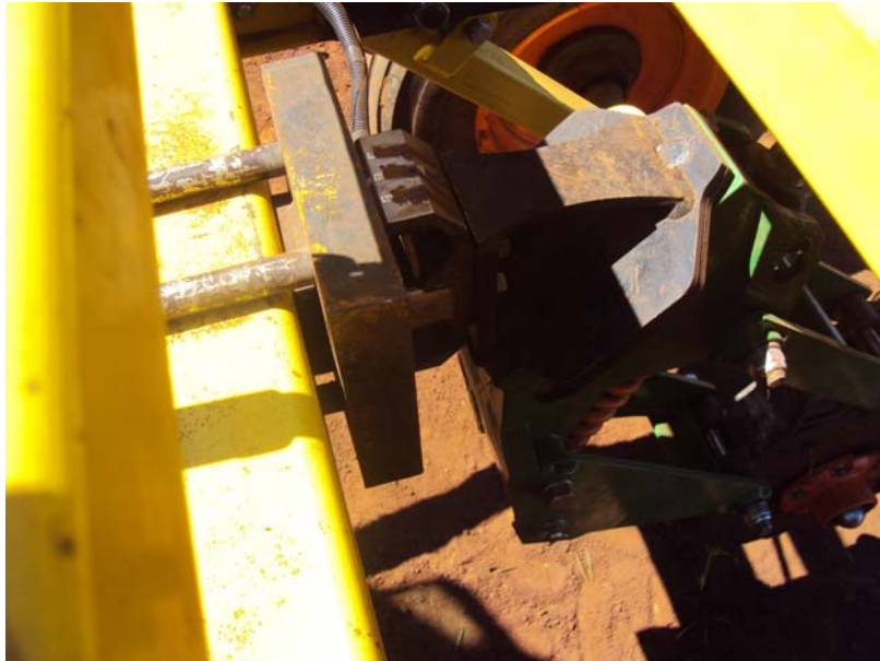
Figura 24 - Fixação da linha no carro dinamométrico.
