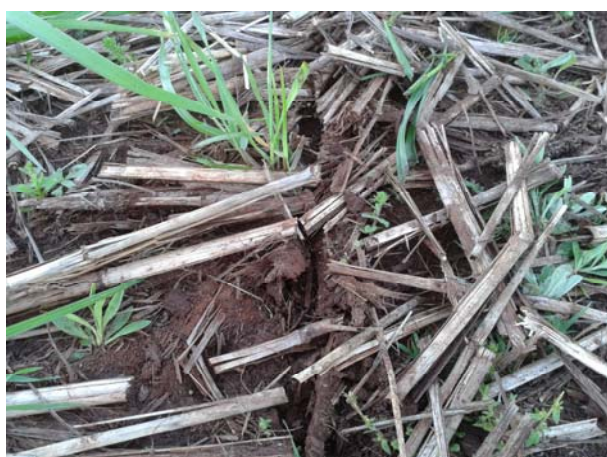
Figura 20 - Suporte de 38° na velocidade de 12 km/h, 50 mm profundidade.
