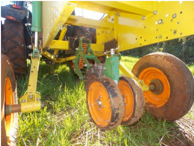
Figura 26 - Unidade de teste, linha de plantio direto.
