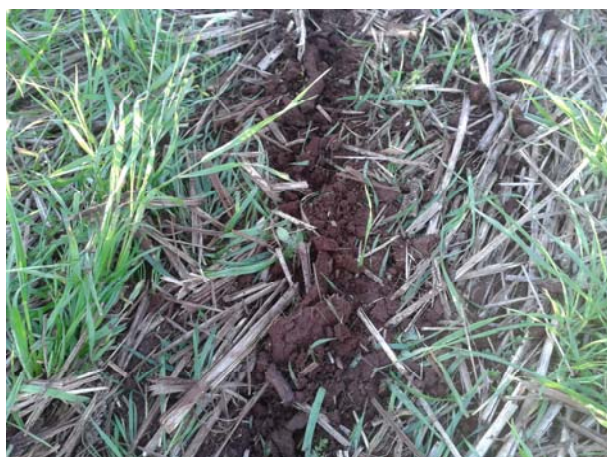
Figura 18 - Suporte de 36° na velocidade de 12 km/h, 50 mm profundidade.
