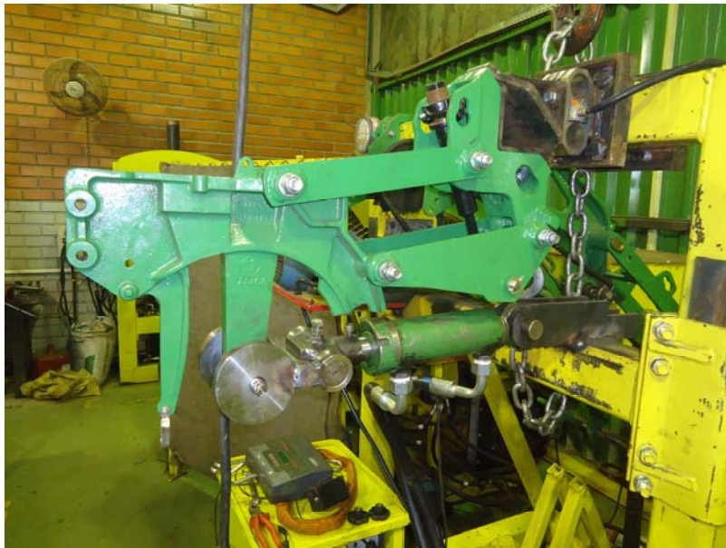
Figura 22 - calibração do anel octogonal.
