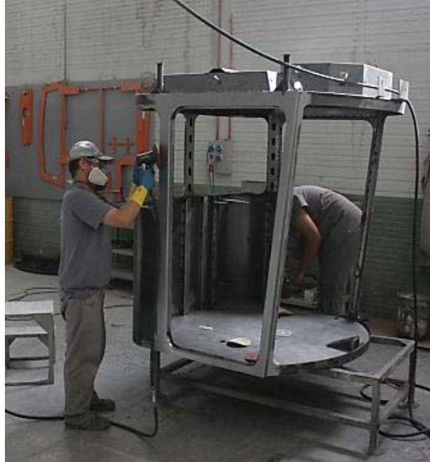
Figura 6 - Processo de lixamento e Esmerilhamento.
