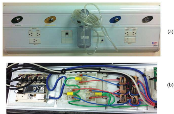
Figura 3 – Protegemed em 2015, visão frontal (a) e interna (b) [10].
