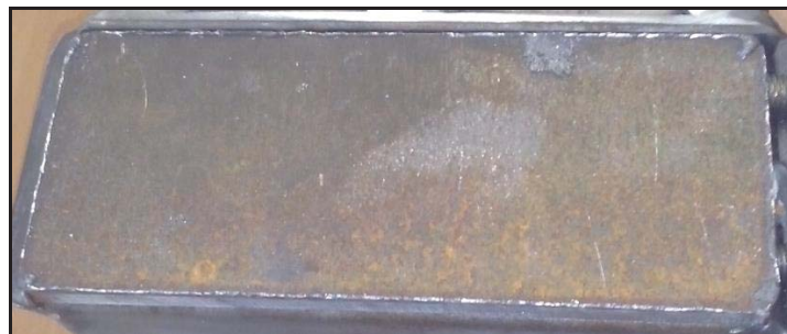
Figura 35 – Fotografia de um corpo de prova com rebarba
