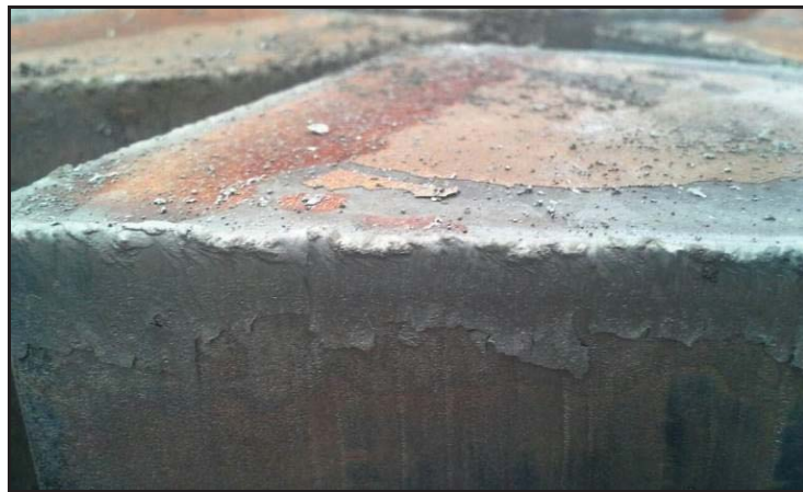
Figura 19 - Fotografia de uma peça com rebarbas geradas por um processo de corte térmico.
