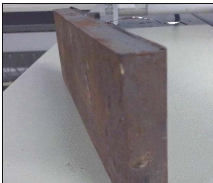
Figura 18 – Fotografia de uma peça com rebarbas geradas por um processo de corte mecânico.
