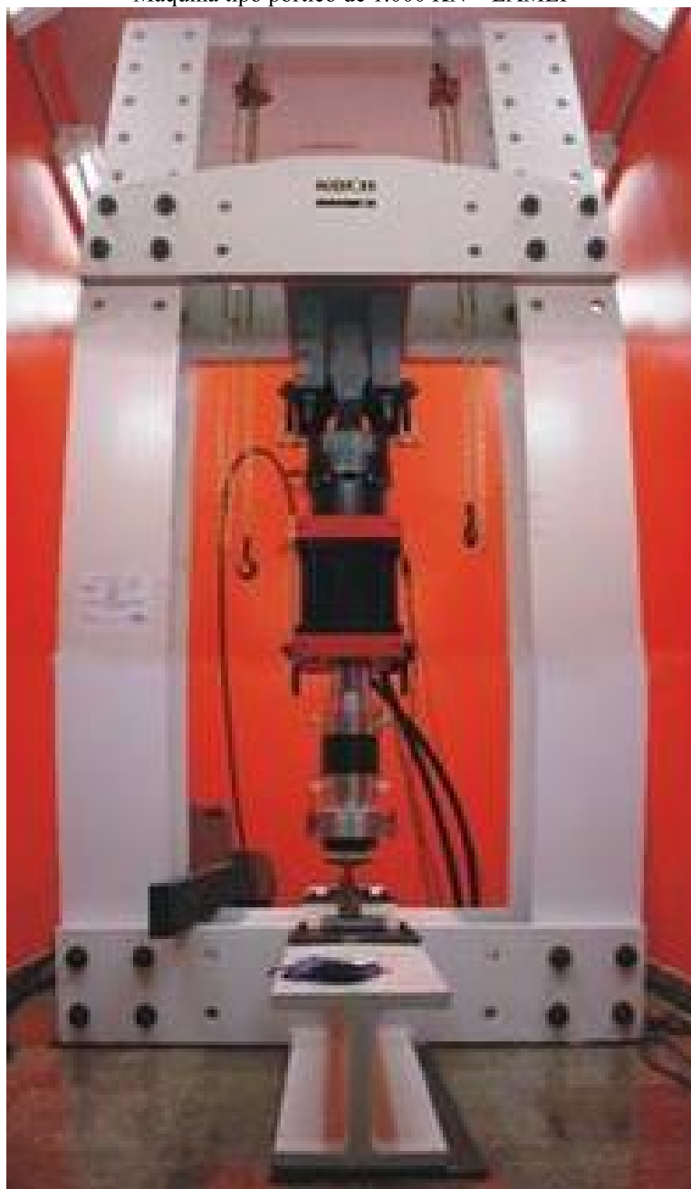
Máquina tipo pórtico de 1.000 KN – LAMEF
