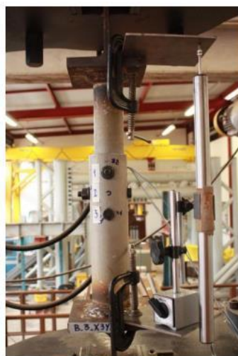
(a) Vista do ensaio, com posicionamento do transdutor de deslocamento (LVDT).
