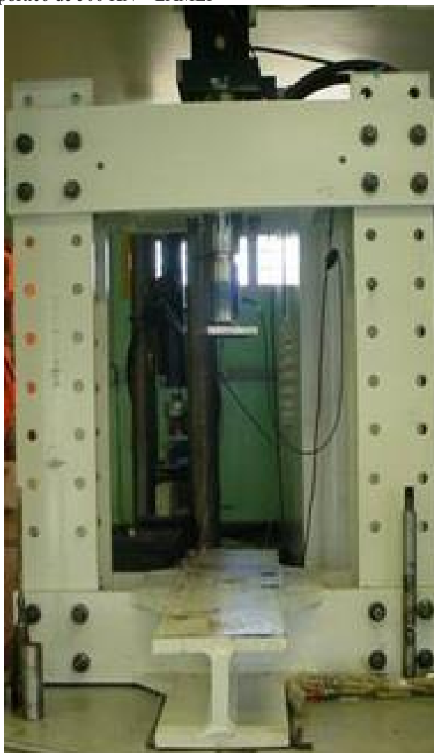
Figura 27 – Máquina tipo pórtico de 500 KN – LAMEF
