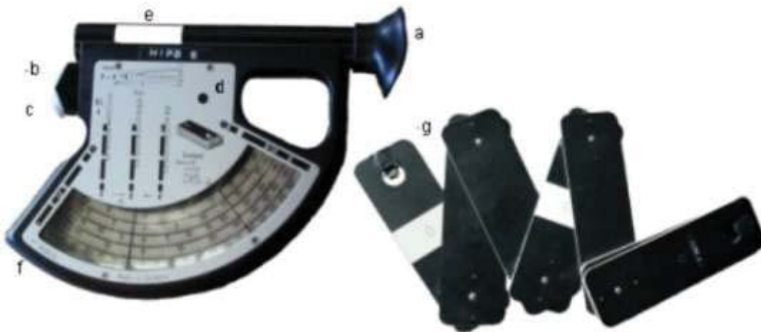
Figura 23: Hipsómetro de Blum-Leiss: (a) ocular, (b) botão, libertador/fixador do ponteiro da leitura de topo, (c) botão libertador/fixador do ponto de leitura da base, (d) ocular lateral, (e) indicadores de movimento dos ponteiros, (f) escalas (15, 20, 30 e 40) de declives e (g) mira. Fonte: Barreiro & Tomé (2005).
