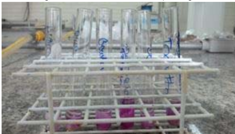
Figura 21: Filtros de \text{NO}_2 em solução reagente
