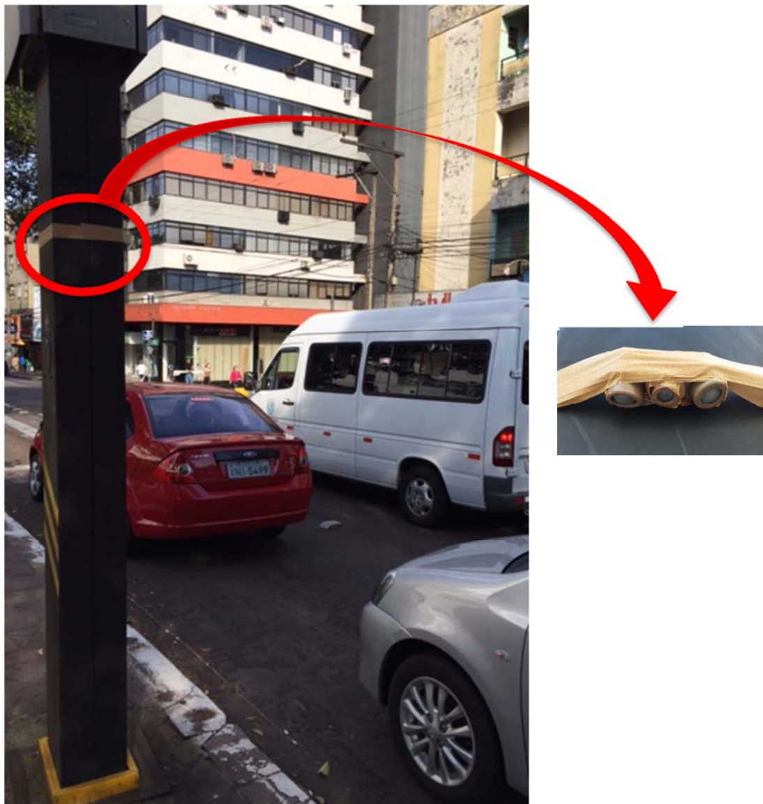
Figura 17: Ponto de coleta com conjunto de amostradores P3
