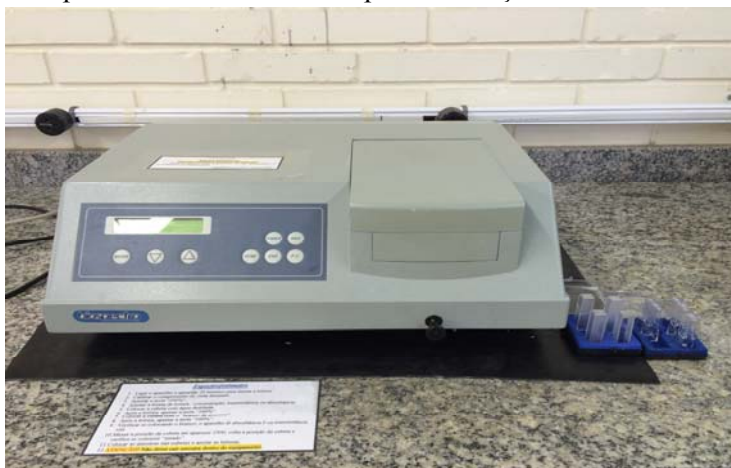
Figura 22: Espectrofotômetro UV/VIS para realização da leitura da absorbância
