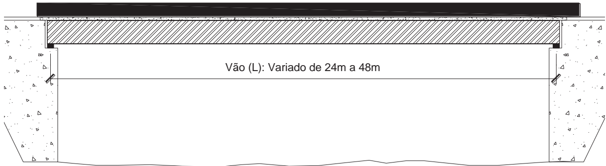
Figura 25: Vista lateral do modelo de ponte estudado
