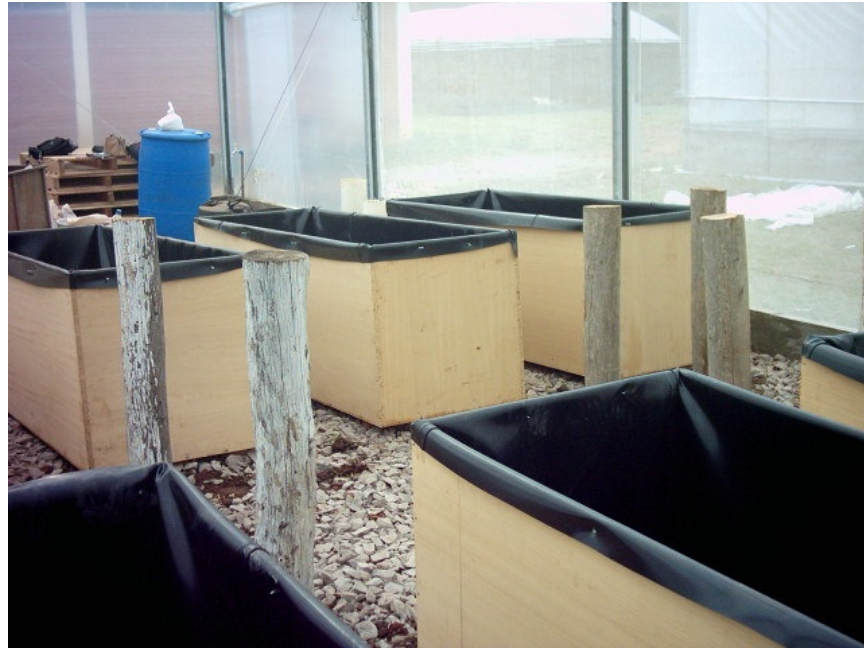
Figura 9 - Leitos construídos de madeira compensada.
