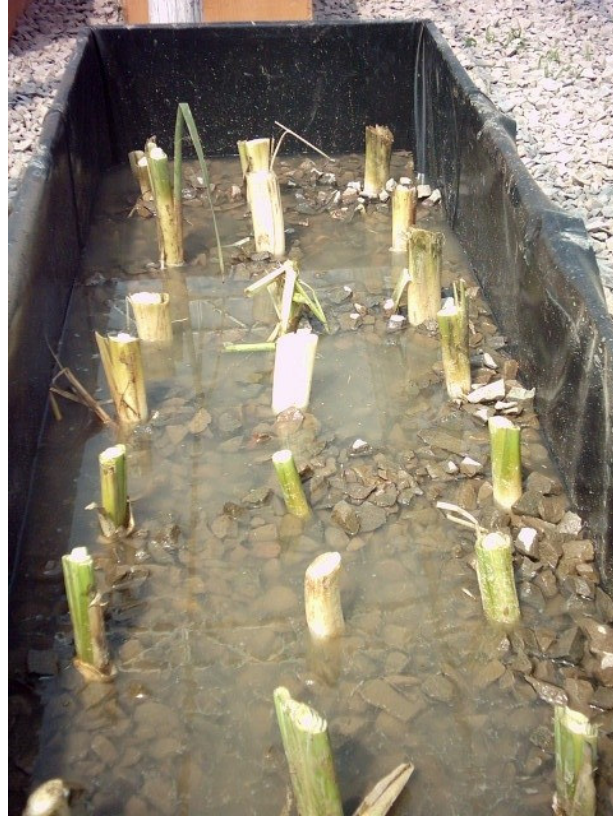
Figura 18 – Representação da lâmina de água utilizada para adaptação das macrófitas nos leitos cultivados.
