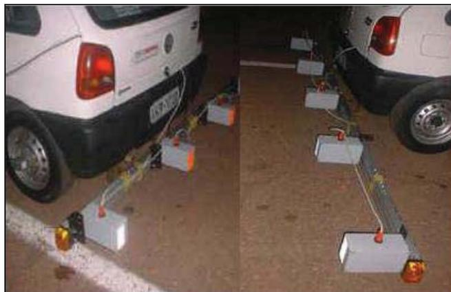
Figura 3 - Perfilômetro Laser
