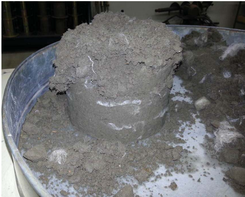
figura48: Aspecto não homogêneo nas misturas com grandes teores de fibras.
