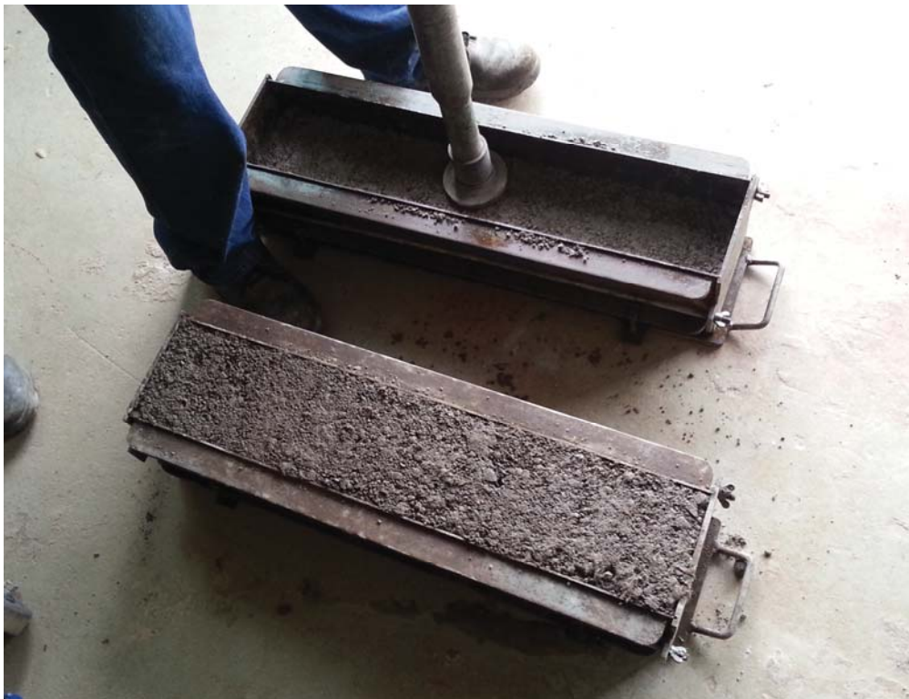
figura 42: Corpos-de-prova utilizados para os ensaios de retração;
