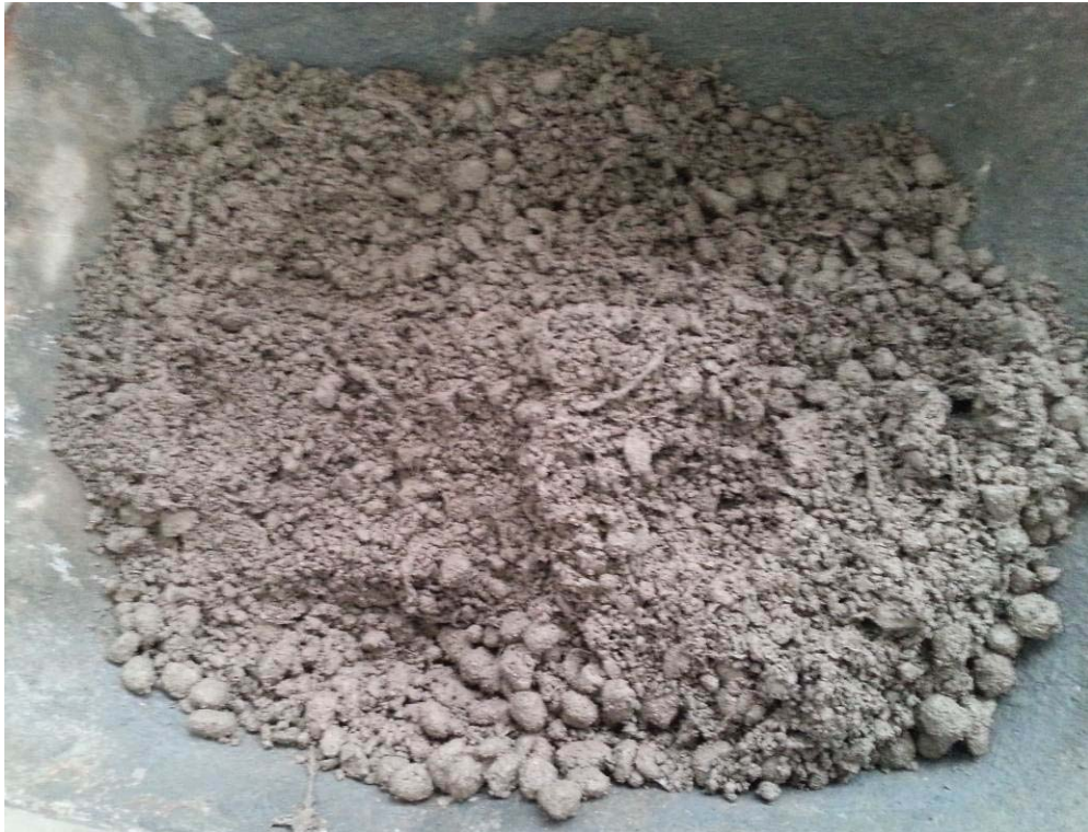
figura 35: Aspecto da mistura logo após a retirada da betoneira;
