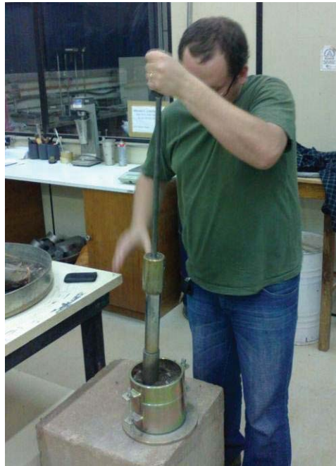
figura 37: Execução do ensaio de Proctor
