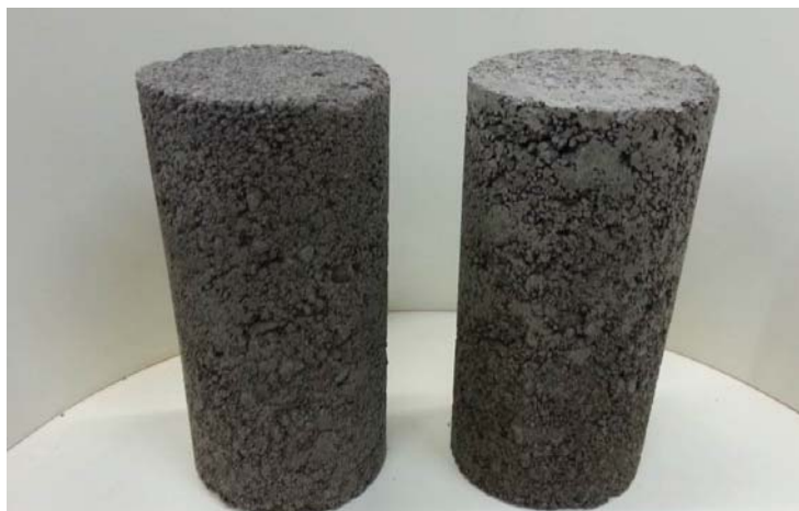
figura 40: Corpos-de-prova moldados para os ensaios de compressão axial e diametral;
