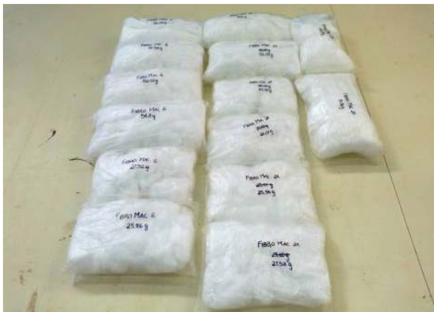
figura 32: Fibras preparadas para serem misturadas no ensaio de Proctor
