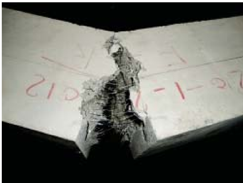
figura 17: Concreto reforçado com fibra metálica
