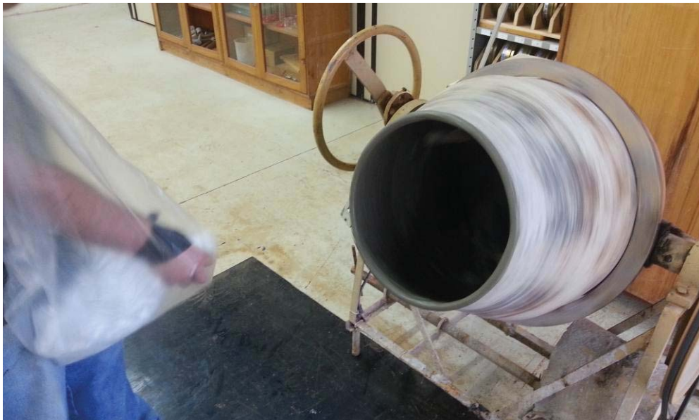
figura 34: Misturas dos materiais, momento da adição das fibras
