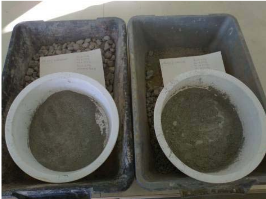
figura 33: Material preparado (Agregados, cimento e fibras) para a realização dos ensaios de Proctor
