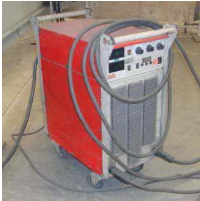
Figura 24 - Máquina de solda FCAW usada na produção das emendas.
