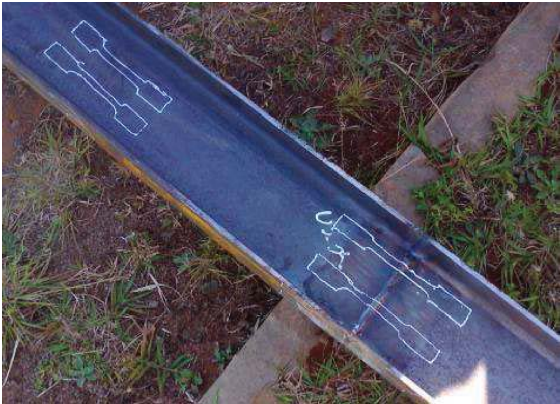
Figura 39 - Localização para extração dos corpos de prova para ensaios de tração.
