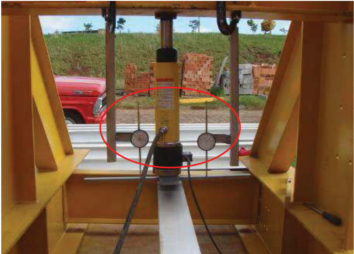
Figura 34 – Medição com medidores de deslocamento analógicos
