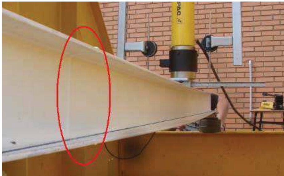
Figura 36 Deslocamento na viga com uma emenda
