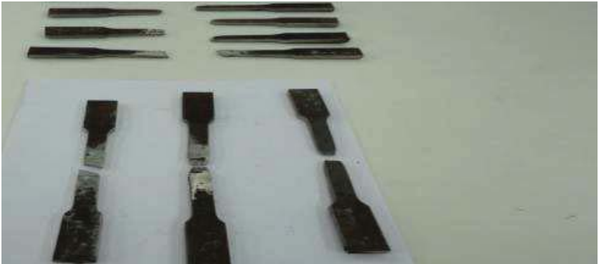
Figura 43 Corpos de prova ensaiados à tração
