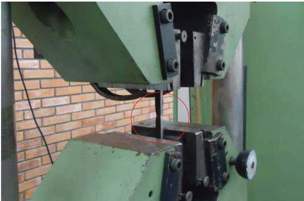
Figura 42 Ensaio de tração, mostrando o momento de escoamento do corpo de prova.
