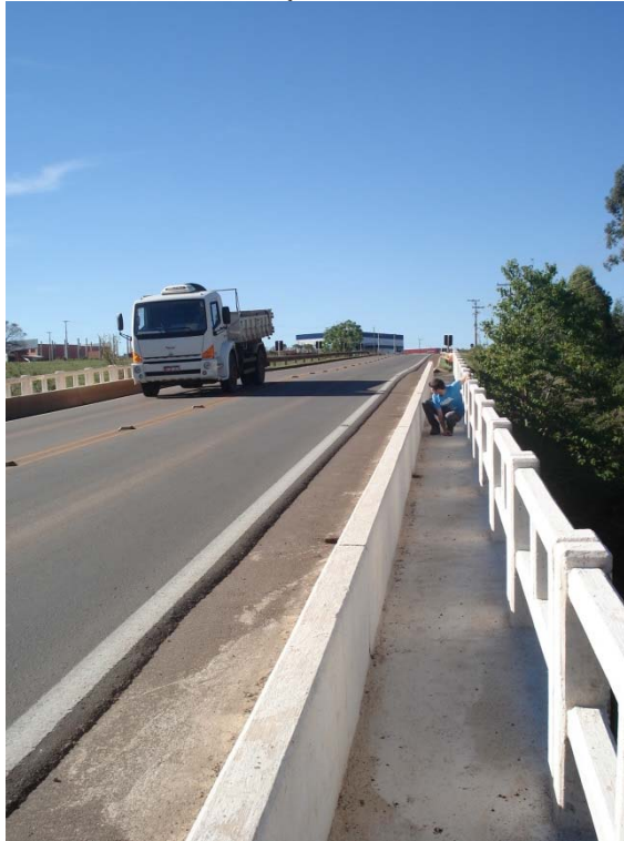
Figura 67: Fonte de vibração utilizada na amostra 5 - V2
