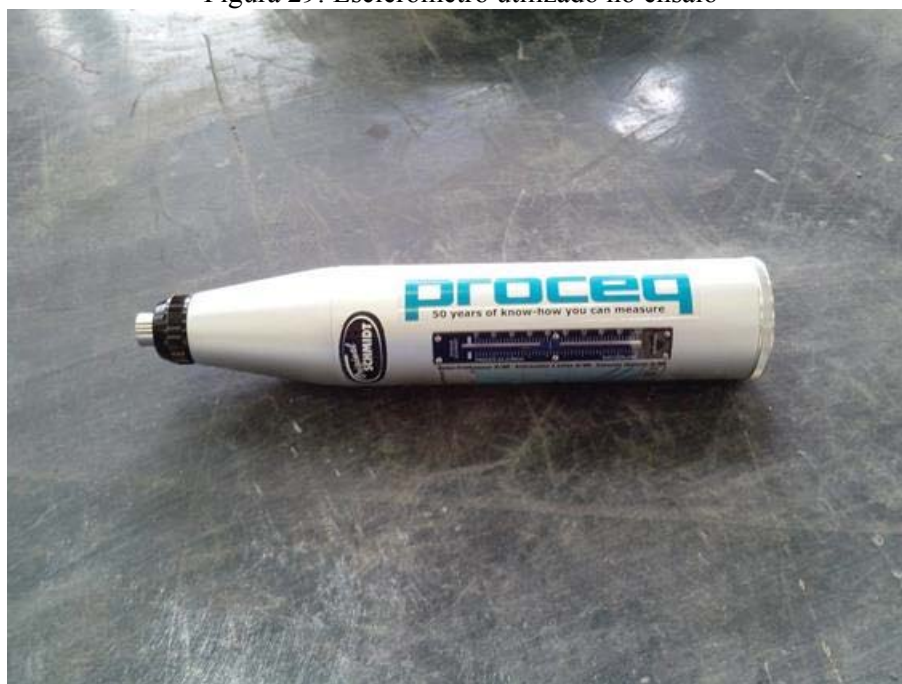
Figura 29: Esclerômetro utilizado no ensaio
