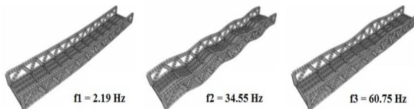
Figura 20: Formas modais de vibração da ponte
