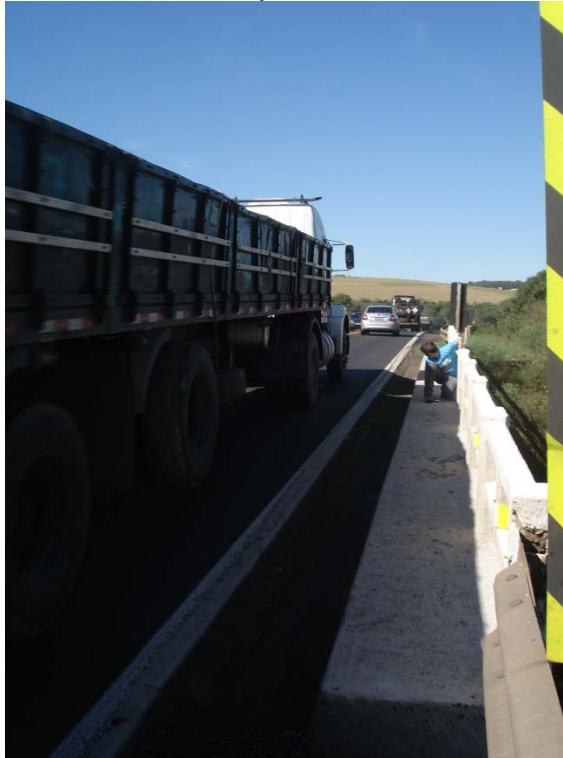
Figura 47: Fonte de vibração utilizada na amostra 6 - V1
