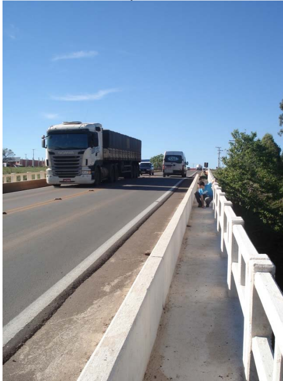
Figura 69: Fonte de vibração utilizada na amostra 6 - V2
