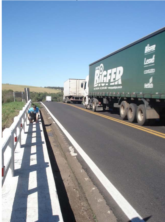
Figura 41: Fonte de vibração utilizada na amostra 3 - V1
