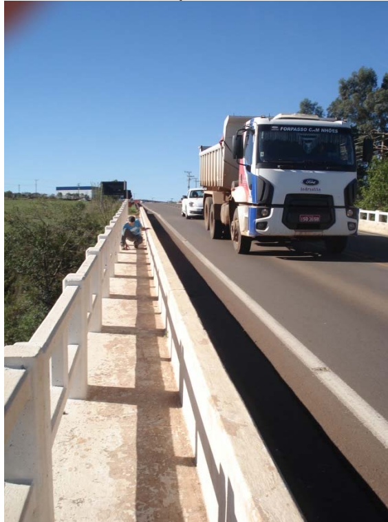
Figura 63: Fonte de vibração utilizada na amostra 3 - V2
