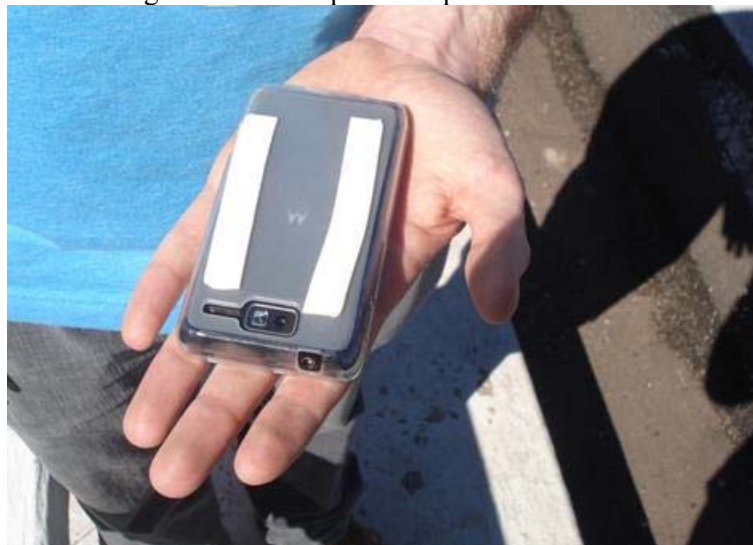
Figura 34: Fita dupla face aplicada ao celular
