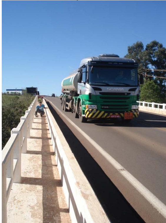
Figura 61: Fonte de vibração utilizada na amostra 2 - V2
