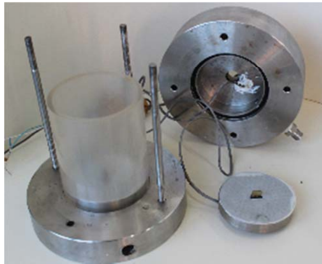
Figura 25 - Câmera de ensaio adaptada com bender elements.
