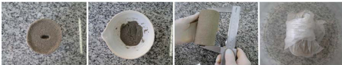
Figura 40 - Preparação dos corpos de prova sem parede para os ensaios de rigidez.
