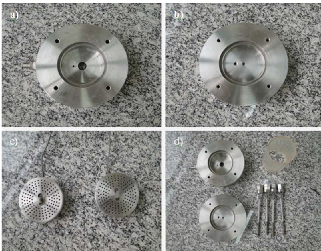
Figura 45 - Peças usinadas para a adaptação do equipamento de coluna com bender elements: a) Top cap; b) base cap; c) disco drenante superior e inferior com sensores bender elements; d) peças câmara de ensaio.
