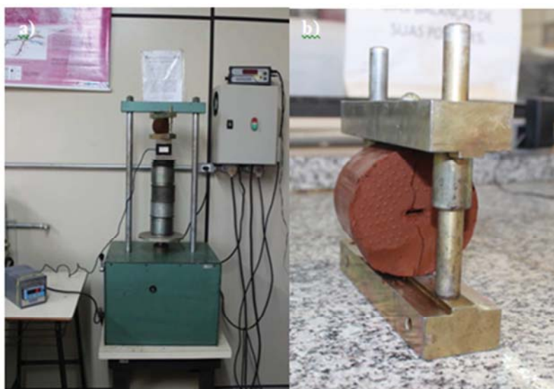
Figura 43 - Execução do ensaio de resistência ao cisalhamento. (a) Ensaio de RCD; (b) Detalhe da forma de ruptura.
