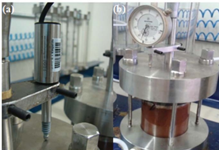
Figura 23 - Detalhe do sistema de medição de recalques: (a) LVDT; (b) medidor analógico.
