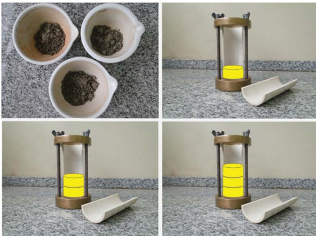
Figura 38 - Procedimento de moldagem do corpo de prova.
