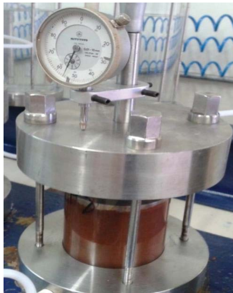
Figura 21 - Detalhe do sistema de medição de recalques.
