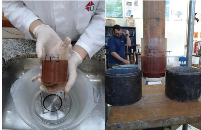
Figura 26 - Desmontagem da câmara de percolação e extração do corpo de prova ensaiado.
