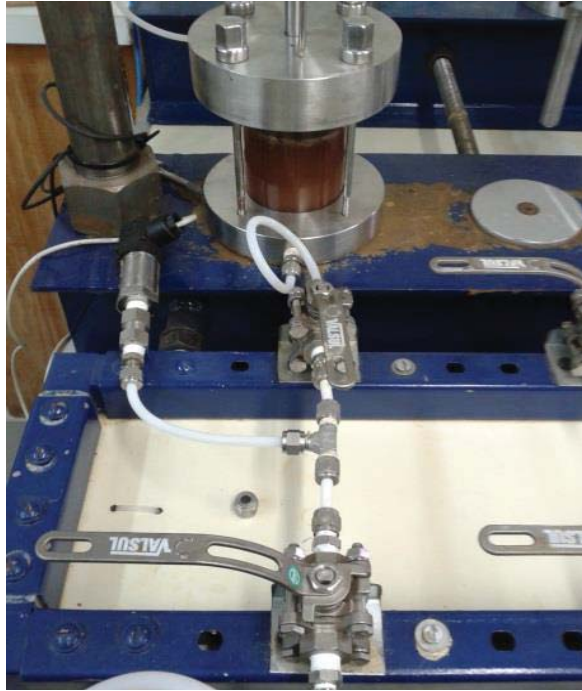
Figura 20 - Conexões de entrada e válvulas para a medição das pressões internas.
