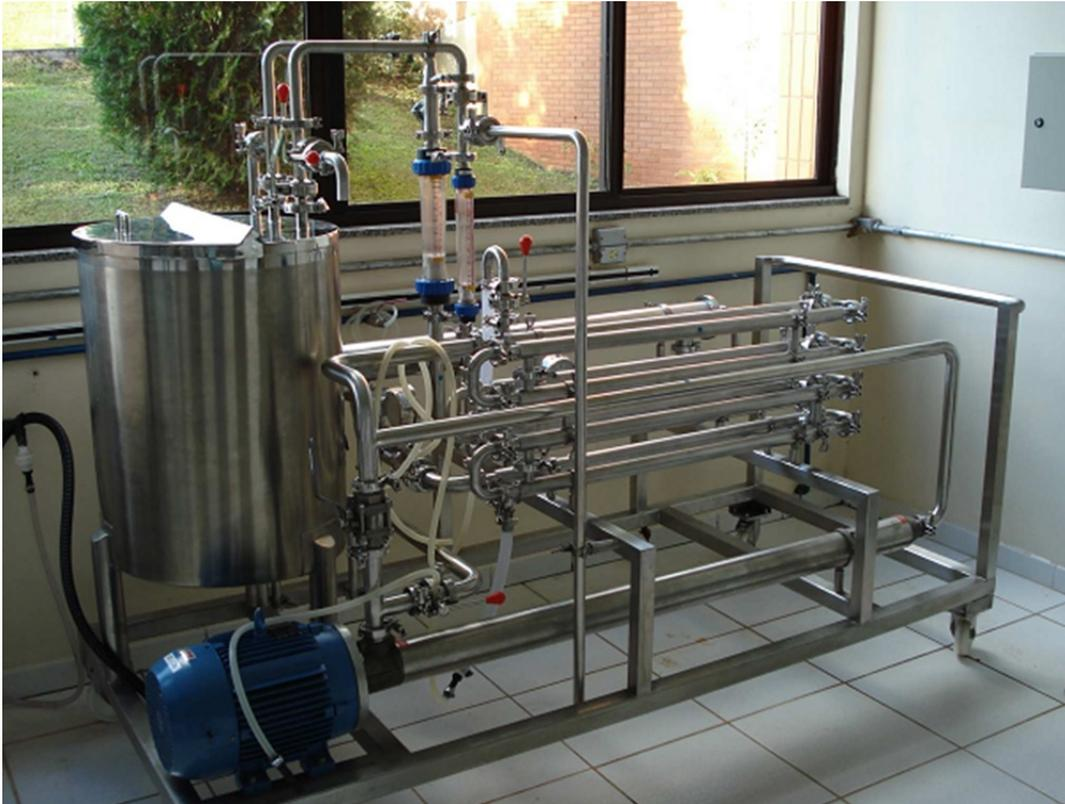
A Figura 15 apresenta o diagrama esquemático do sistema. Aproximadamente 30 L de efluente foram utilizados para alimentação do tanque durante a realização de cada experimento. O efluente foi impulsionado por uma bomba centrífuga multiestágios através da carcaça onde é instalada a membrana, sendo separada em duas correntes: permeado e retido. Permeado e retido foram recirculados para o tanque de alimentação, de onde foram novamente impulsionados através da membrana.
