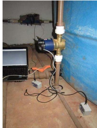
Figura 43: Coleta de dados na entrada de água potável do reservatório inferior de água pluvial H3
