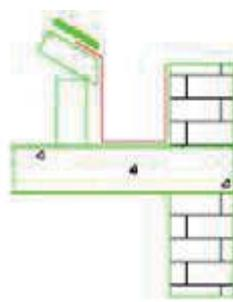
Figura 08: Calha água furtada
