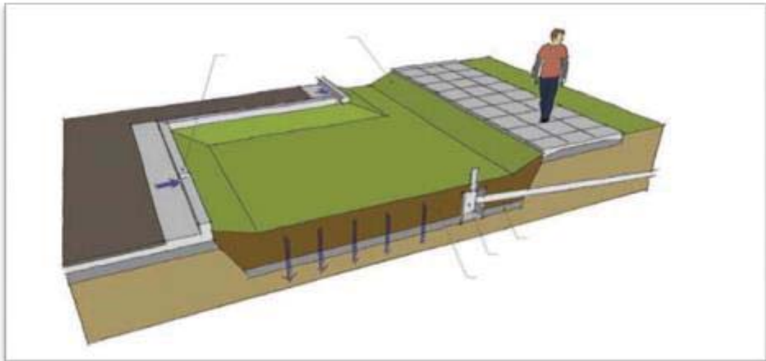
Figura 3 - Esquema de um jardim de chuva.
