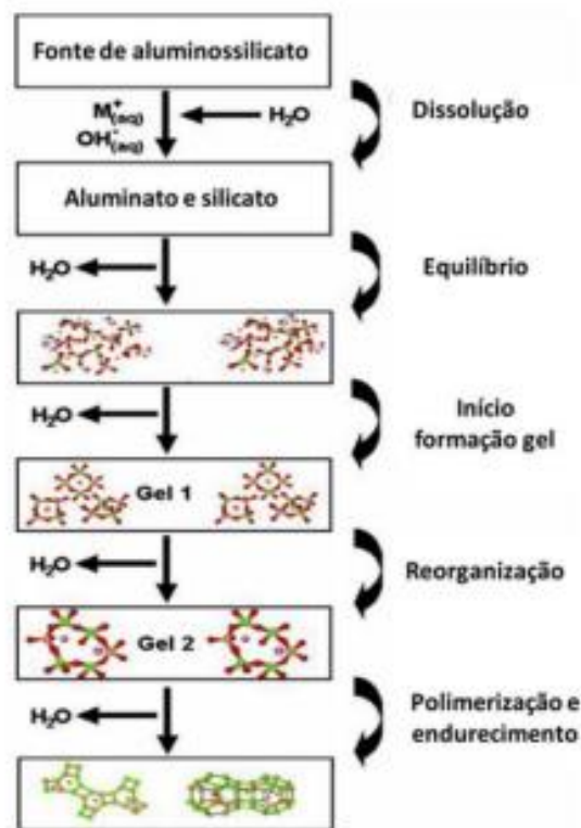
Figura 15: Modelo de reação da ativação alcalina de geopolímeros
