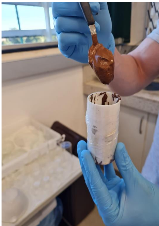
Figura 27: Moldagem dos corpos de prova
