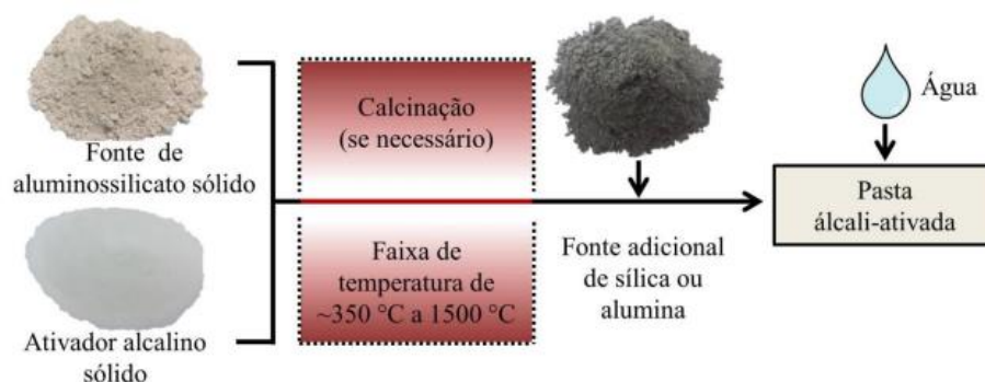
Figura 14 b: Esquema one-part-mix
