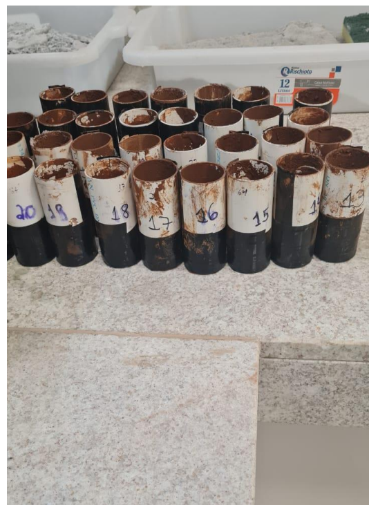
Figura 27: Moldagem dos corpos de prova
