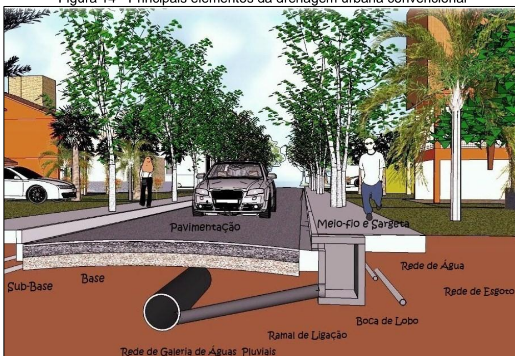
Figura 14 - Principais elementos da drenagem urbana convencional
