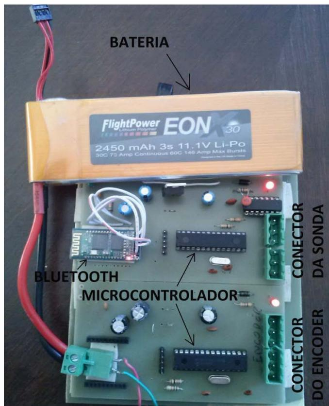
Para o projeto da fonte e dimensionamento da bateria foram utilizados conhecimentos práticos e dados sobre os componentes da fonte. Ainda, foi inserido um diodo 1N4007 em série com a fonte para evitar danos aos componentes eletrônicos da placa, caso houver a inversão dos polos da bateria. O diodo 1N4007 apresenta capacidade de corrente de 1 A e uma tensão reversa típica de 0,7 V, para o sentido de condução direta.
