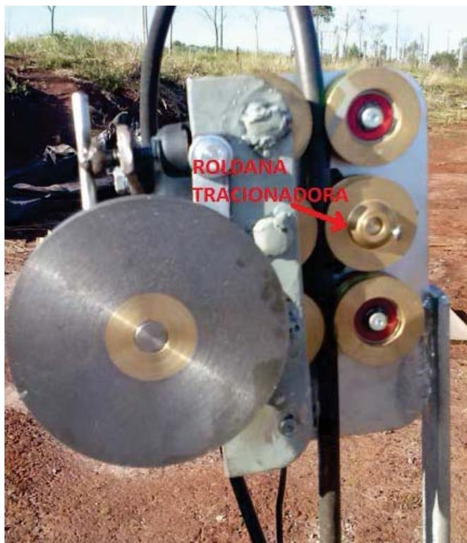
Figura 35. O sistema de medição de profundidade com vista traseira.
