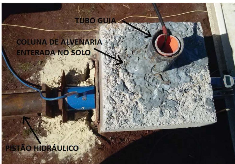
As estacas de concreto apresentam tubos guias de 65 mm de diâmetro interno com quatro ranhuras guias e profundidade de instalação de 8 m. As colunas são submetidas a esforços transversais e pontuais localizado na parte superior da mesma, sendo esperado um comportamento curvo da coluna após a aplicação dos esforços.
