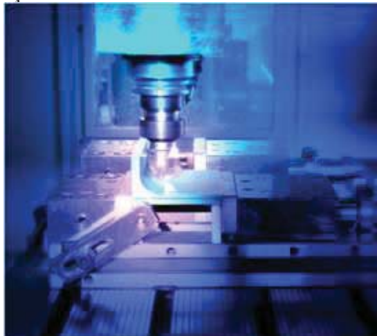
Figura 16: Exemplo de fabricação de componente de uma estrutura de aço com auxílio de software TecnoCam.
