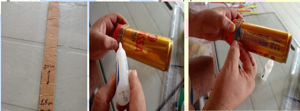
Figura 31 - Colando a tira em EVA na lata com uso do guia em papelão
