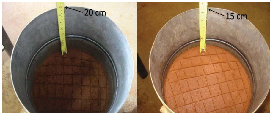
Figura 20: Compactação da camada 1 e 2 do corpo de prova.
