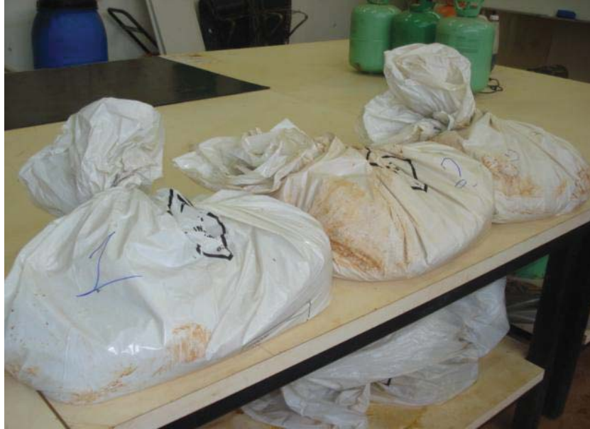
Figura 11: Armazenagem do solo antes da moldagem dos corpos de prova.
