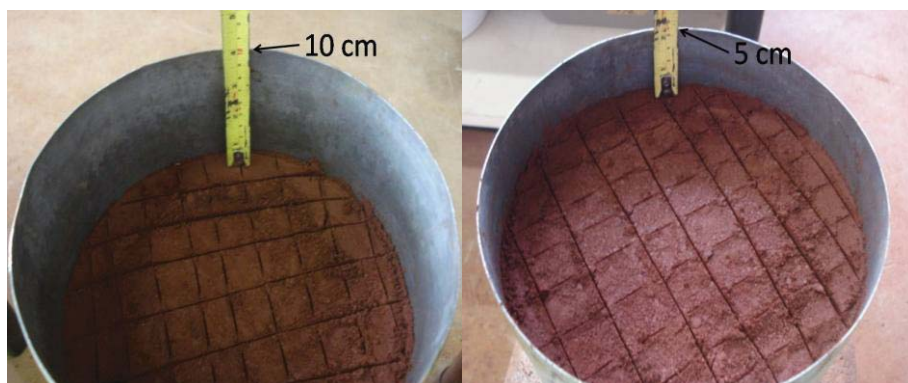
Figura 21: Compactação da camada 3 e 4 do corpo de prova.
