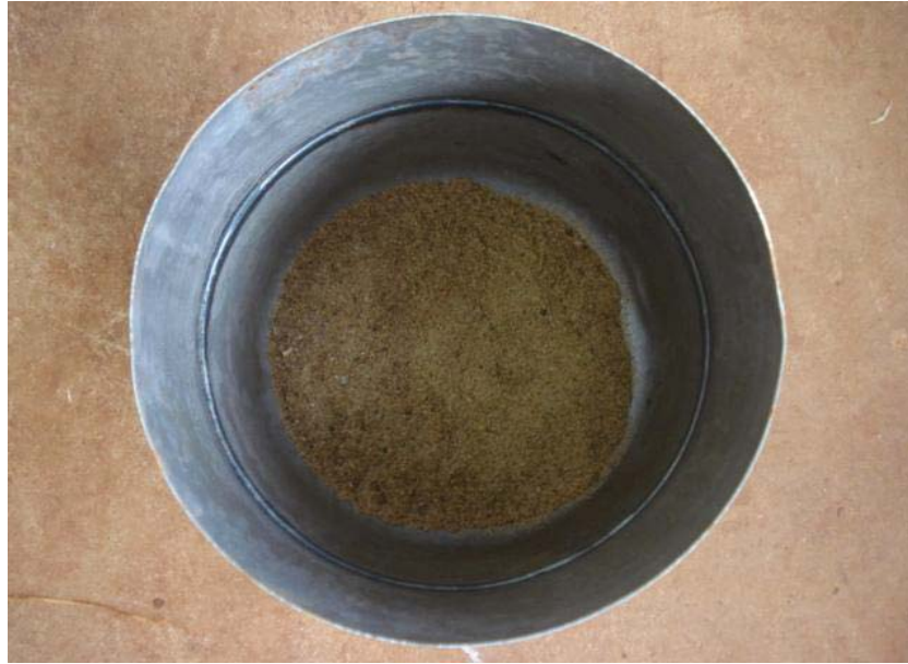
Figura 18: Camada drenante de areia.
