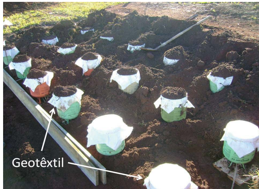
Figura 25: Preenchimento com solo e geotêxtil sobre os biorreatores.
