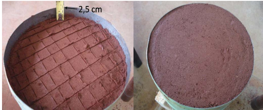
Figura 22: Compactação da camada 5 do corpo de prova.
